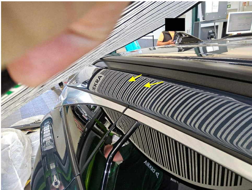
Bild 11 : Dachholm rechts Dellen
