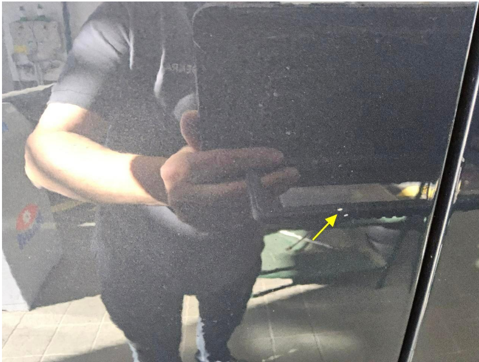
Bild 12 : Tür vorn links Lackierung beschädigt, auslegen
