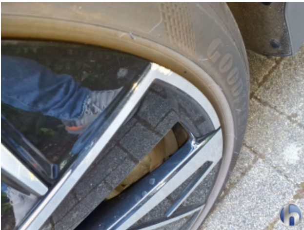
3. Felge Hinten - Rechts Kratzer - Smart Repair
