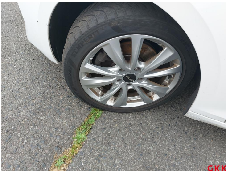
Bild 15. Reifen, vorne links, einseitig abgefahren, ersetzen
