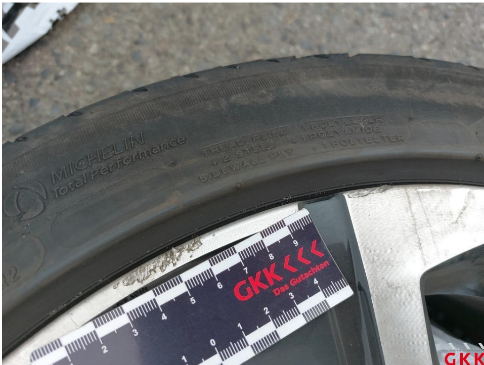
Bild 28. LM-Rad, 1 x beiliegend, Materialabtrag, ersetzen
