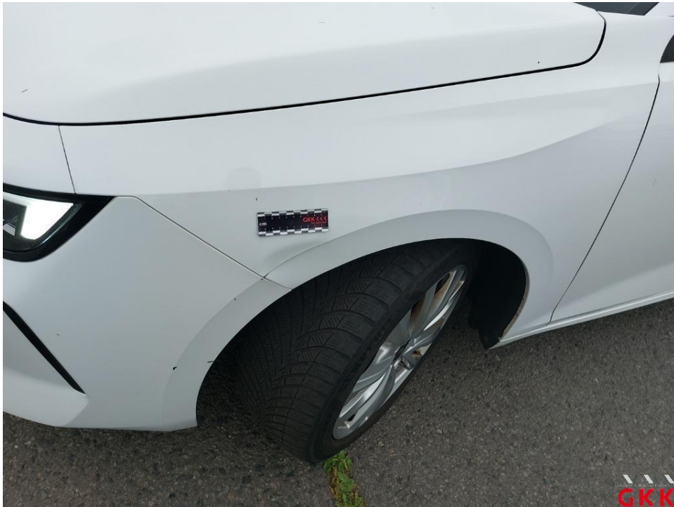
Bild 21. Kotflügel vorne links, beschädigt, ersetzen
