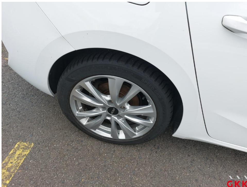
Bild 33. LM-Rad, hinten rechts, verkratzt, ersetzen
