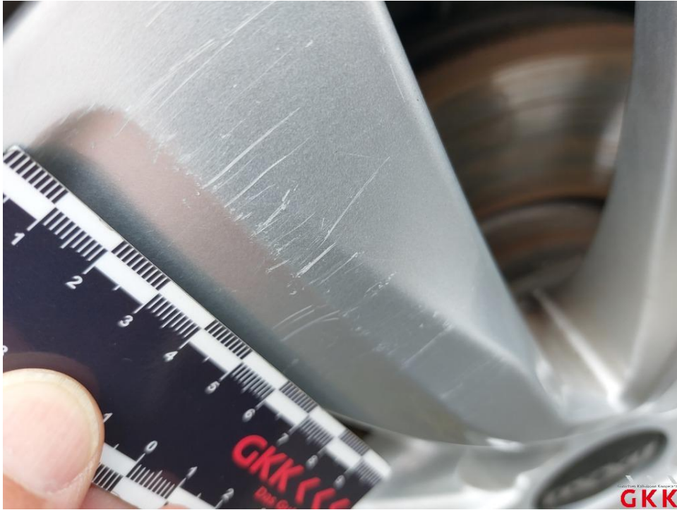
Bild 31. LM-Rad, vorne rechts, verkratzt, ersetzen
