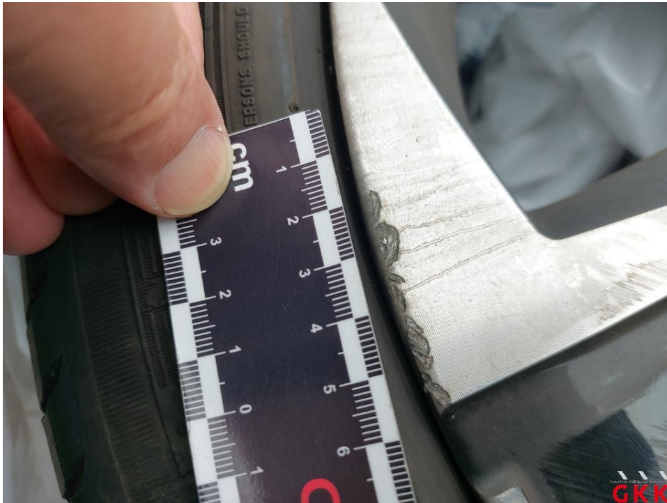
Bild 27. LM-Rad, 1 x beiliegend, Materialabtrag, ersetzen
