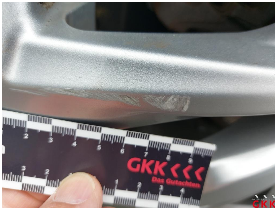
Bild 34. LM-Rad, hinten rechts, verkratzt, ersetzen
