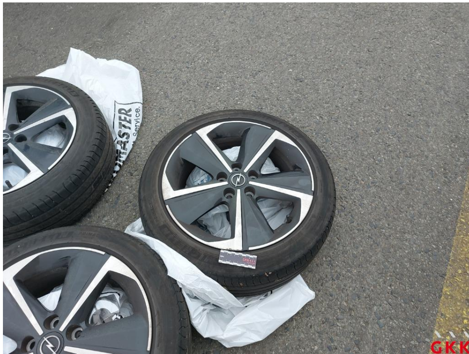
Bild 26. LM-Rad, 1 x beiliegend, Materialabtrag, ersetzen
