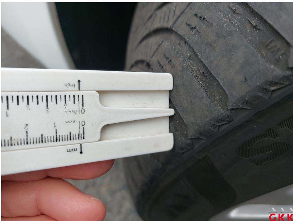
Bild 17. Reifen, vorne links, einseitig abgefahren, ersetzen
