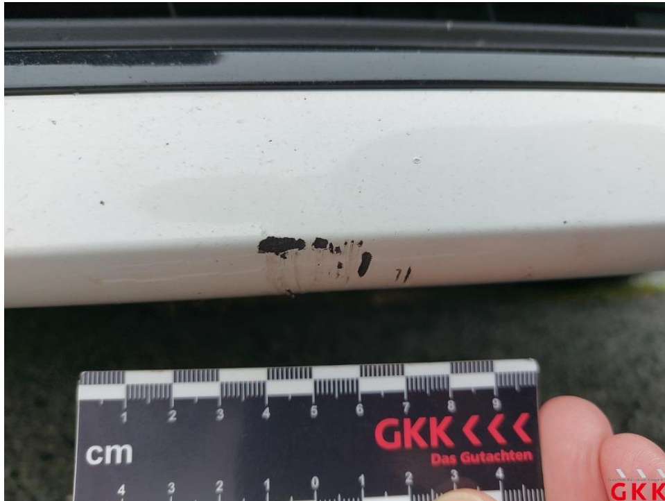
Bild 25. Stoßfänger vorne, Verkleidung -lackiert-, verkratzt, lackieren
