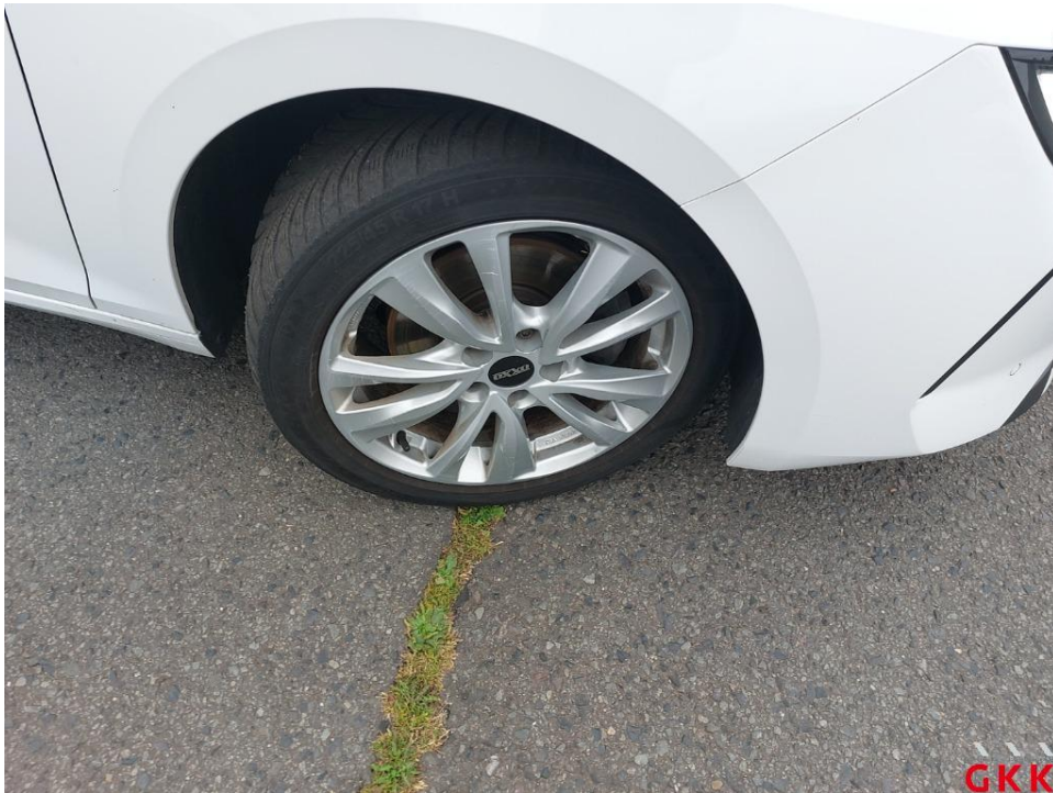
Bild 30. LM-Rad, vorne rechts, verkratzt, ersetzen
