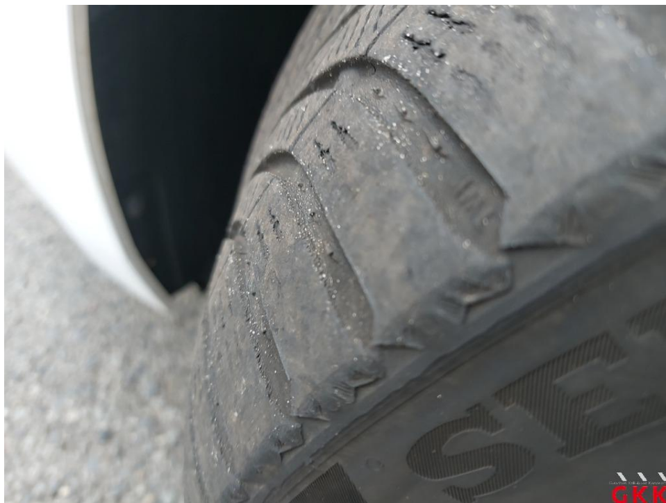
Bild 16. Reifen, vorne links, einseitig abgefahren, ersetzen
