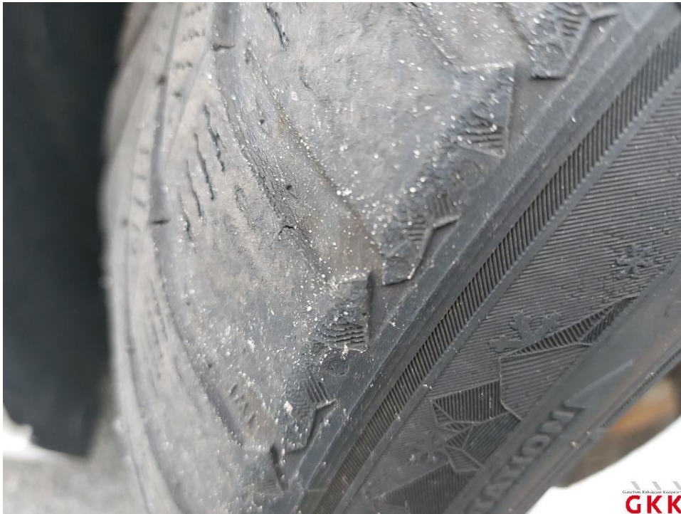
Bild 13. Reifen, vorne rechts, einseitig abgefahren, ersetzen
