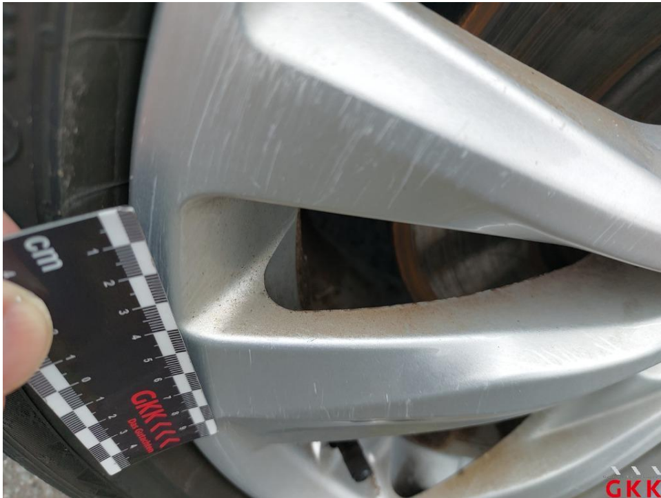
Bild 32. LM-Rad, vorne rechts, verkratzt, ersetzen
