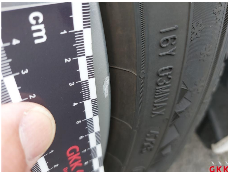
Bild 35. LM-Rad, hinten rechts, verkratzt, ersetzen
