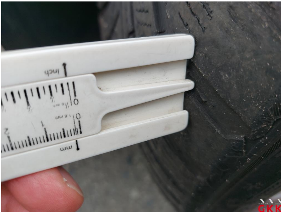
Bild 14. Reifen, vorne rechts, einseitig abgefahren, ersetzen
