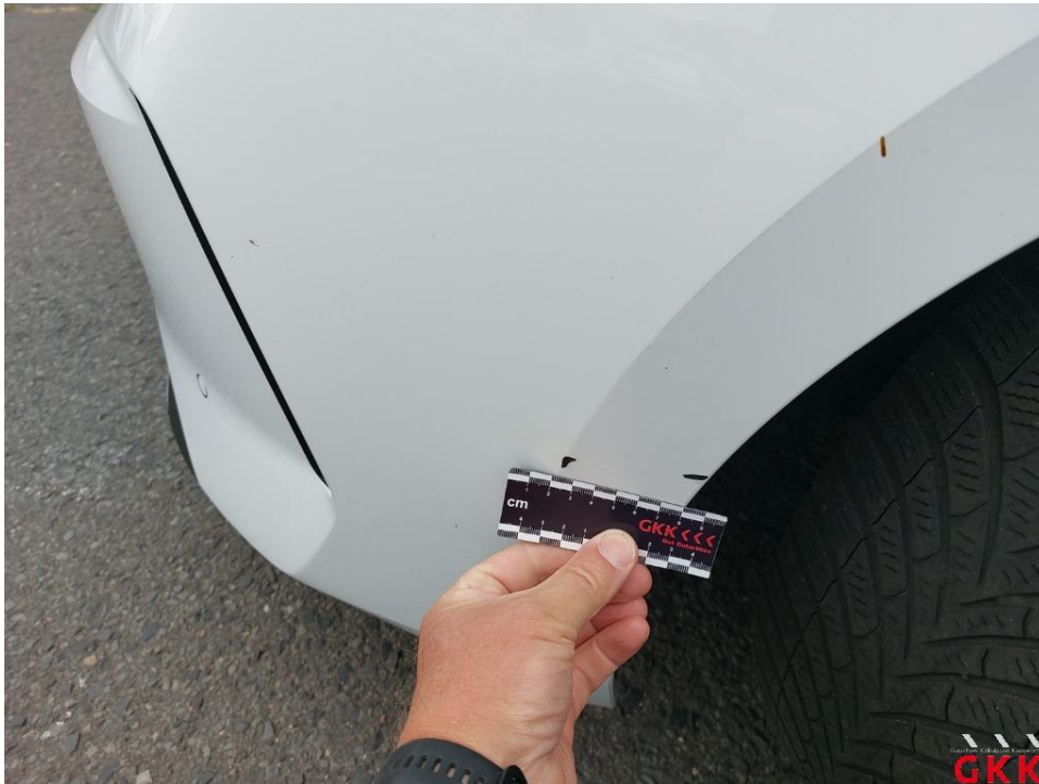
Bild 23. Stoßfänger vorne, Verkleidung -lackiert-, verkratzt, lackieren
