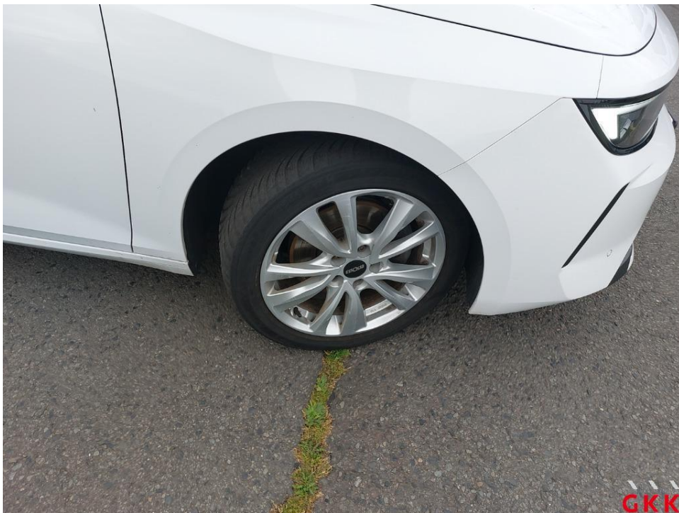
Bild 12. Reifen, vorne rechts, einseitig abgefahren, ersetzen
