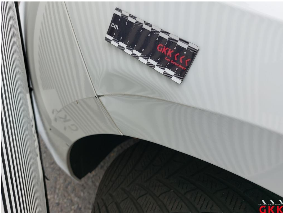
Bild 22. Kotflügel vorne links, beschädigt, ersetzen
