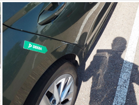
Aleta / Trasero Derecho / Abolladura
