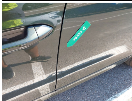
Puerta / Trasero Izquierdo / Mala reparación
