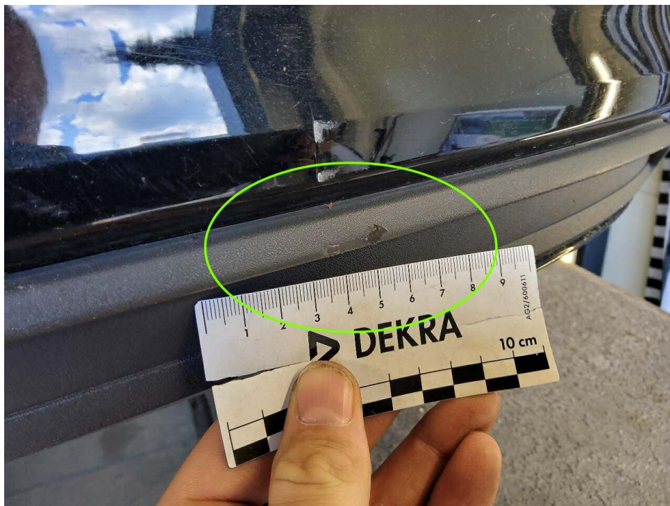
Bild 23 : Stoßfängerabdeckung hinten Unterteil, verschrammt
