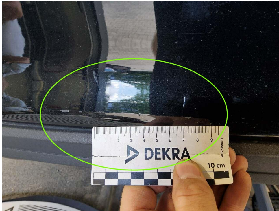
Bild 21 : Stoßfängerabdeckung hinten, verschrammt
