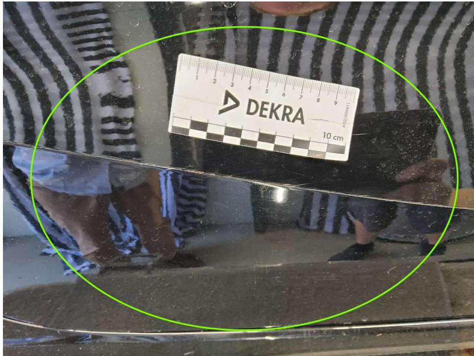
Bild 25 : Tür hinten rechts, mehrfach eingedellt mit Lackschaden
