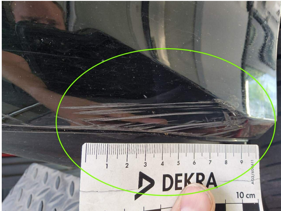
Bild 29 : Stoßfängerabdeckung vorne, verschrammt
