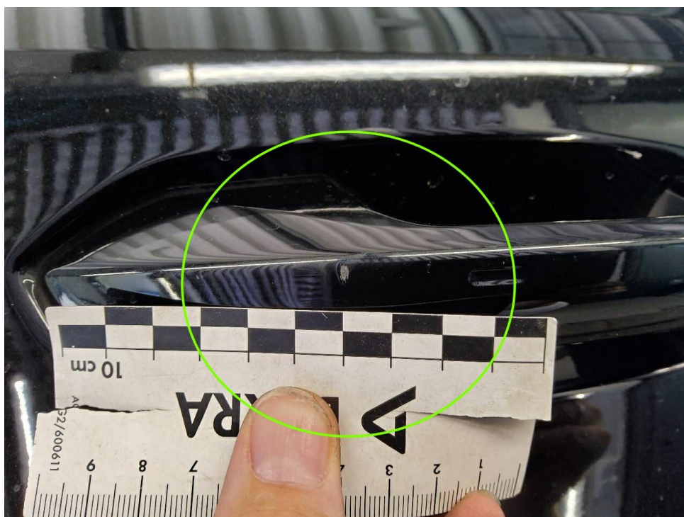
Bild 28 : Türgriff vorne rechts, verschrammt
