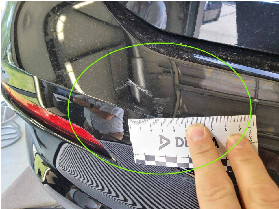
Bild 20 : Stoßfängerabdeckung hinten, verschrammt
