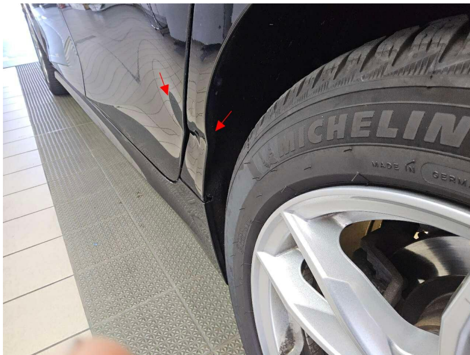
Bild 43 : Fahrzeugseite hinten links: Tür und Seitenwand eingedrückt, deformiert
