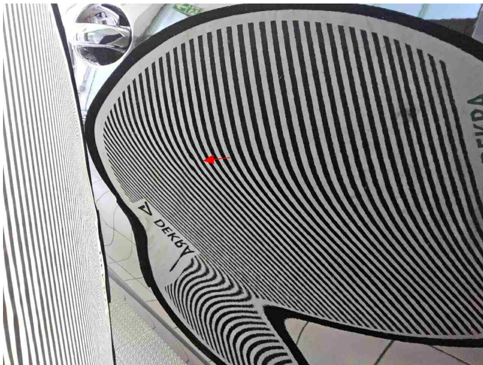
Bild 30 : Tür vorne rechts, eingedellt
