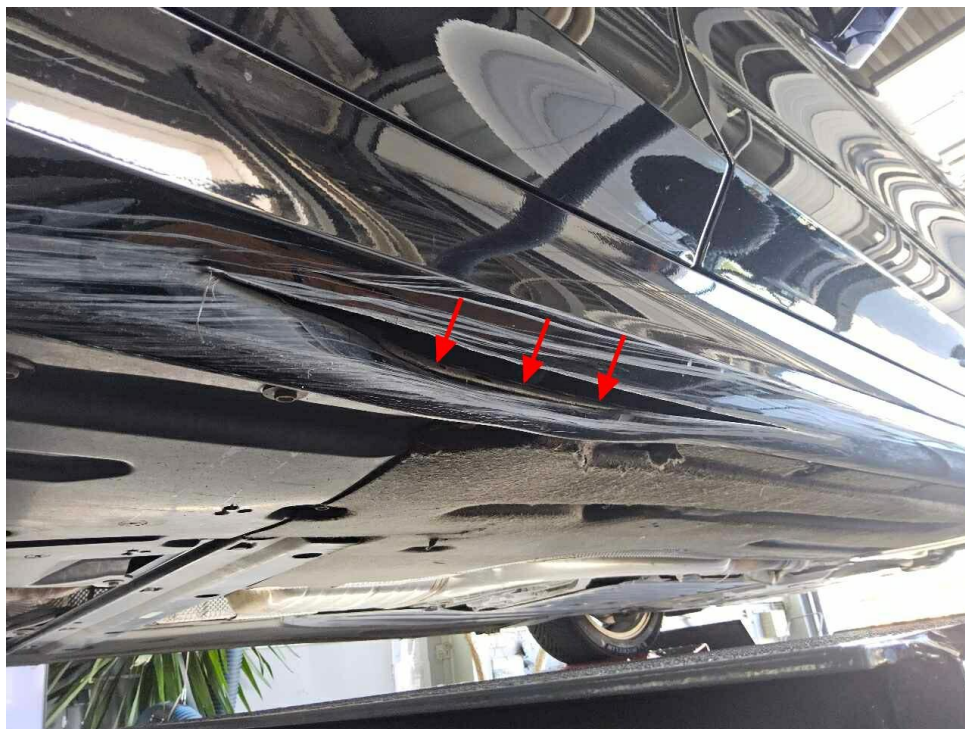
Bild 35 : Seitenschwellerverkleidung rechts gebrochen und aufgerissen, Blech und Aufnahme Unterbodenverkleidung verformt Bodenblech verformt
