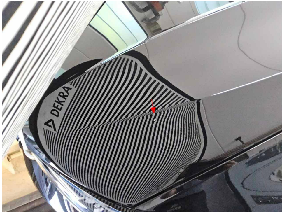
Bild 25 : Motorhaube Lackabplatzer, kleine Delle
