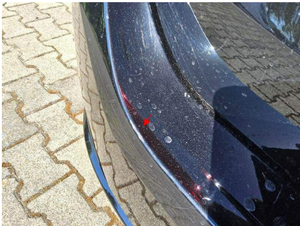
Bild 41 : Stoßfänger hinten Lackierung, zerkratzt
