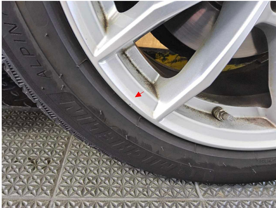
Bild 29 : Felge vorne rechts Lackierung, zerkratzt
