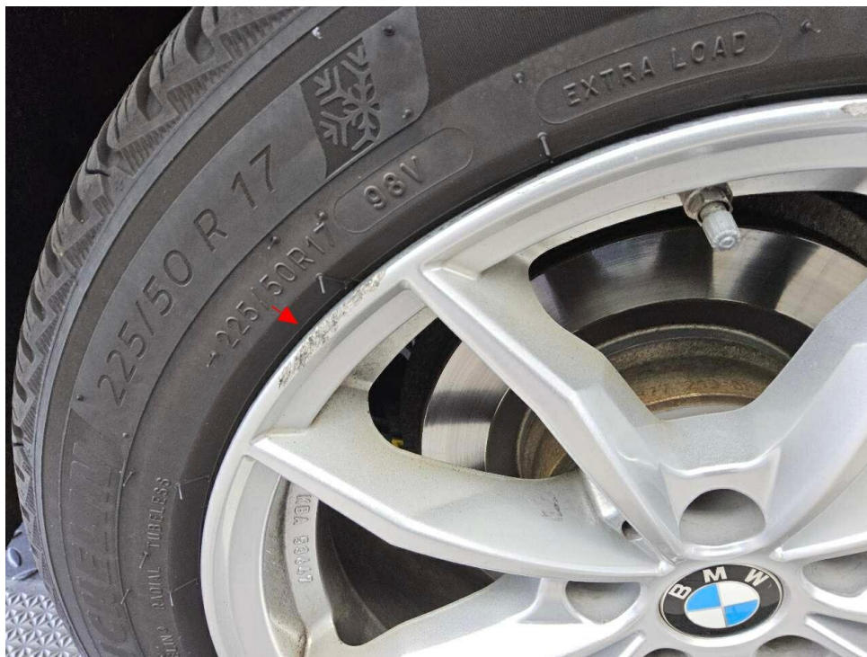
Bild 33 : Felge hinten rechts, verschrammt
