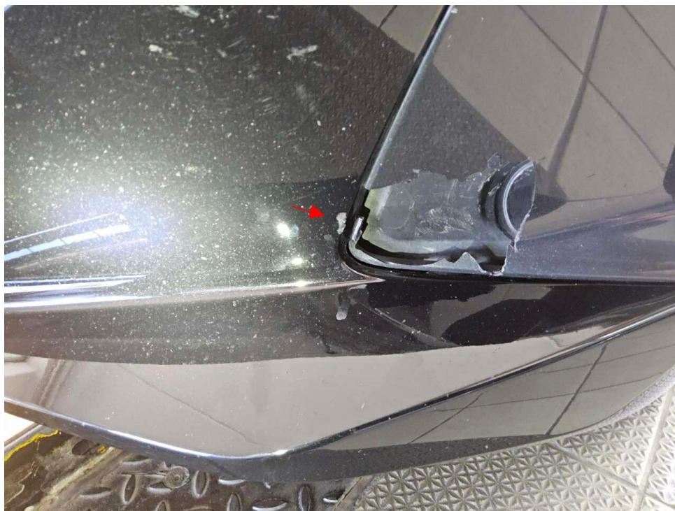
Bild 47 : Stoßfänger vorne, zerkratzt
