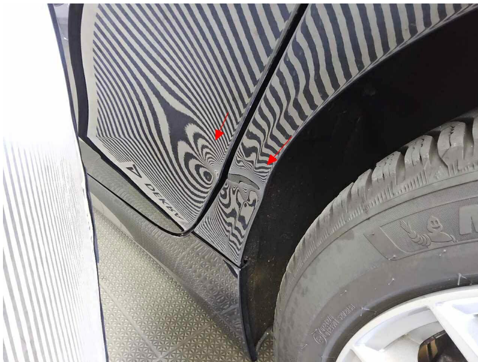
Bild 42 : Fahrzeugseite hinten links: Tür und Seitenwand eingedrückt, deformiert
