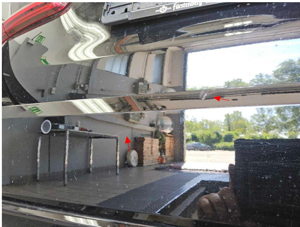
Bild 40 : Stoßfänger hinten Lackierung, zerkratzt, leichte Druckstelle
