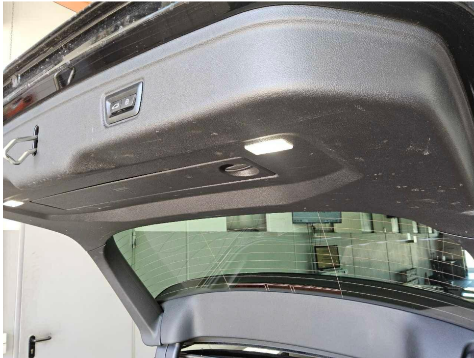
Bild 17 : Kofferraum Kunststoffteile leichte Kratzer
