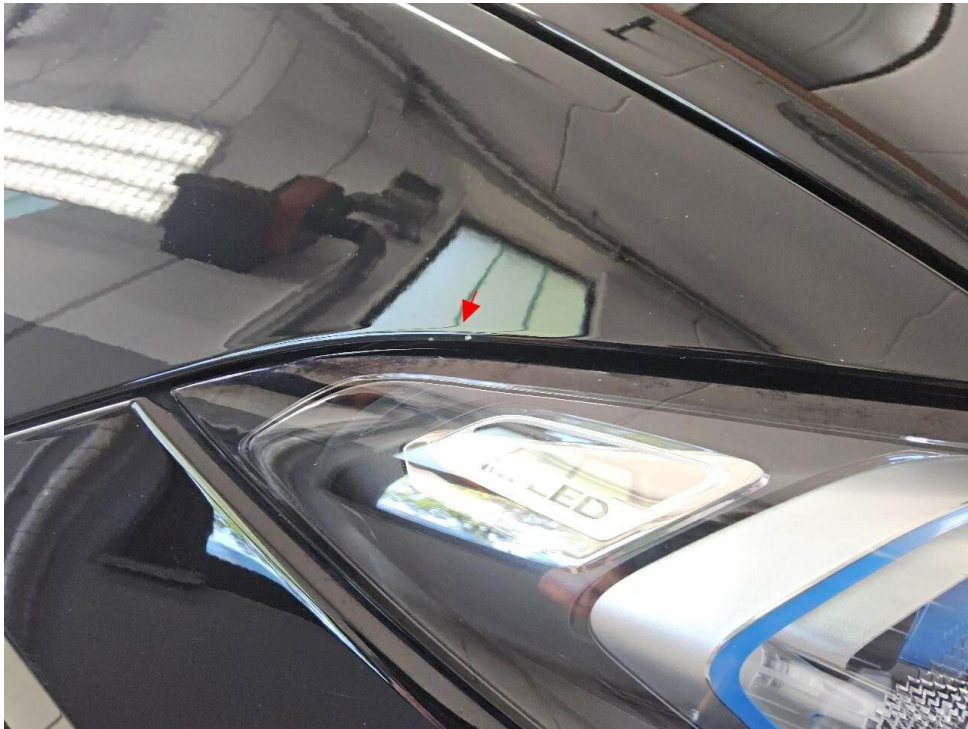
Bild 27 : Kotflügel vorne rechts Lackierung, Steinschlag
