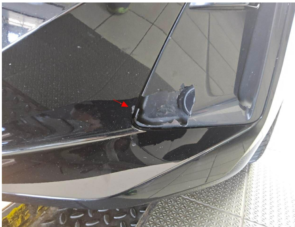
Bild 46 : Stoßfänger vorne Blende gebrochen Stoßfänger zerkratzt
