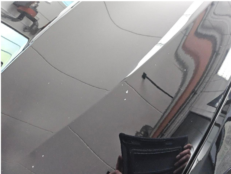
Bild 24 : Motorhaube Lackierung, Steinschläge Lackabplatzer
