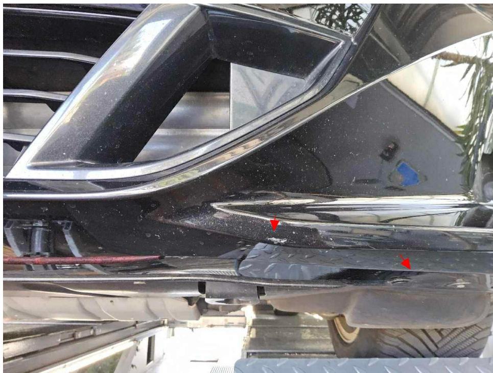
Bild 48 : Stoßfänger vorne, zerkratzt
