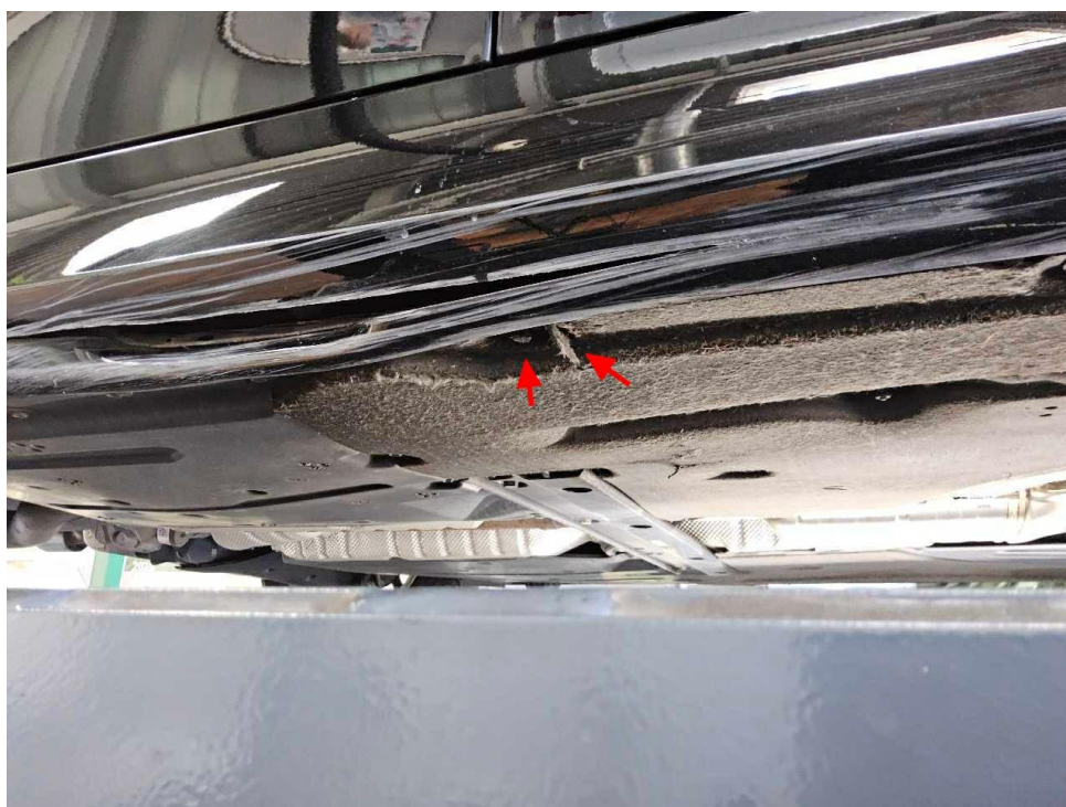
Bild 36 : Aufnahme Unterbodenverkleidung verformt, Verkleidung verformt, aufgeschoben Materialabtrag
