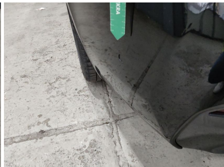
Stoßfänger / Hinten / Schlecht Repariert
