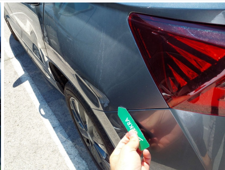
Aleta / Trasero Izquierdo / Abolladura
