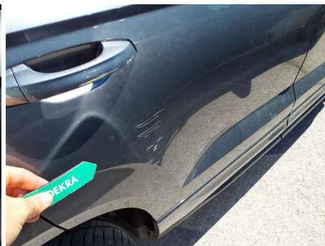
Puerta / Trasero Derecho / Abolladura
