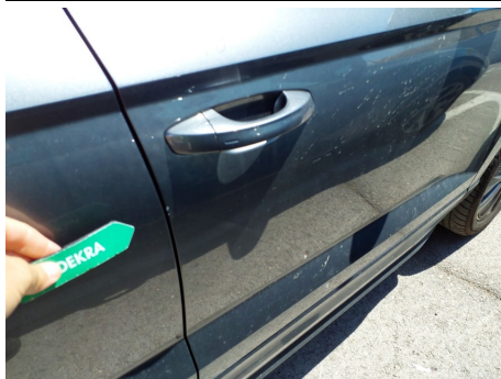
Puerta / Delantero Derecho / Ralladura
