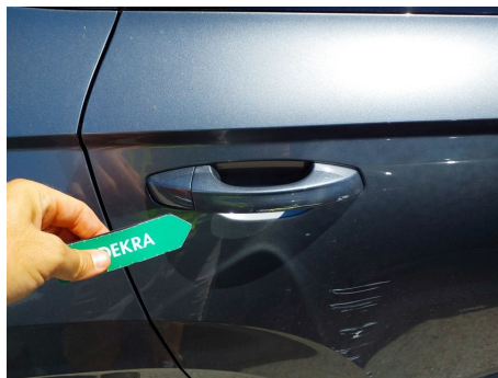
Manetas de puerta / Trasero Derecho / Ralladura
