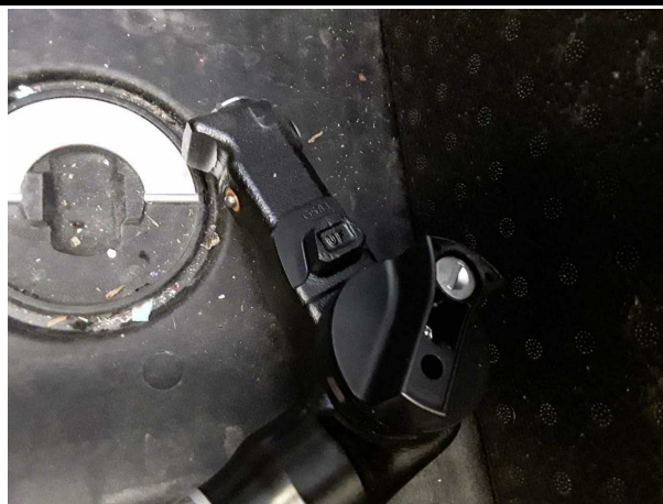
Beschädigung #4: Anhängerkupplung: Anhängerkupplung (Schlüssel fehlen) - erneuern
