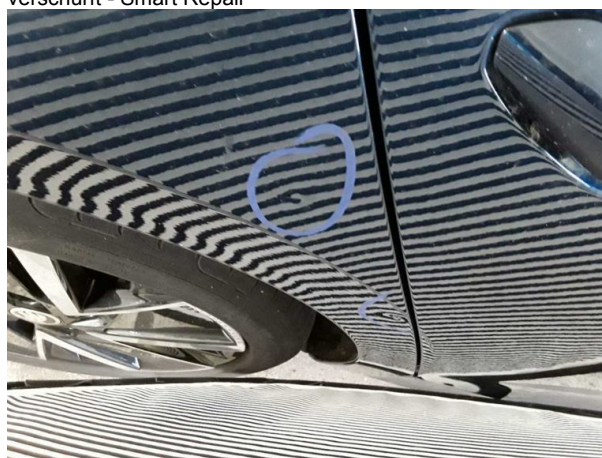
Beschädigung #6: Seitenwand rechts: Seitenwand - Delle / Lackschaden - Smart Repair
