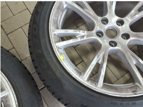
Beschädigung #4: 2.Radsatz: Leichtmetallfelgensatz komplett - verkratzt / verschürft - erneuern
