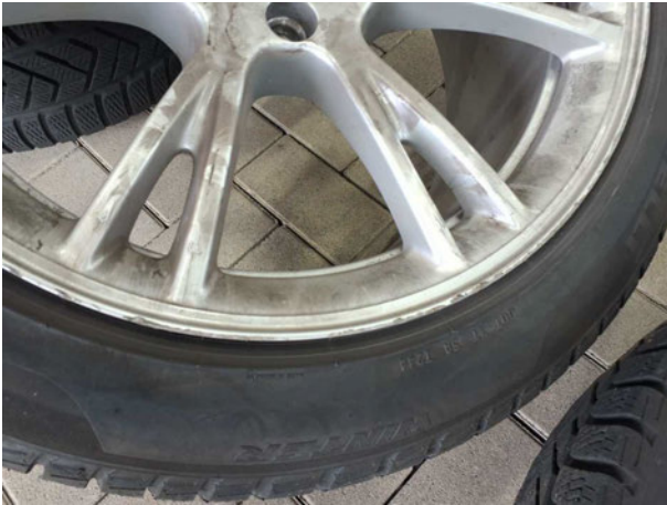
Beschädigung #4: 2.Radsatz: Leichtmetallfelgensatz komplett - verkratzt / verschürft - erneuern
