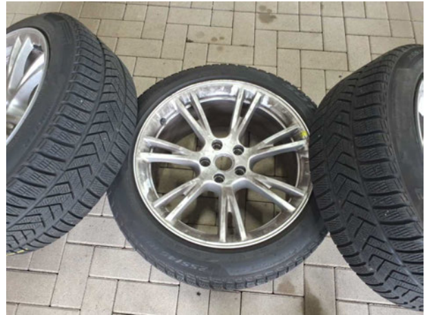
Beschädigung #4: 2.Radsatz: Leichtmetallfelgensatz komplett - verkratzt / verschürft - erneuern
