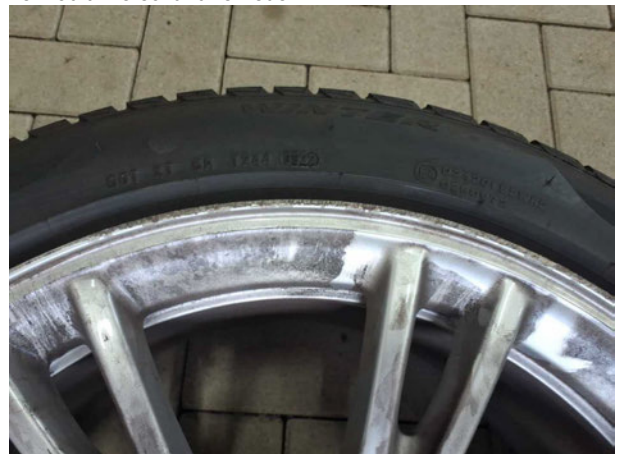
Beschädigung #4: 2.Radsatz: Leichtmetallfelgensatz komplett - verkratzt / verschürft - erneuern
