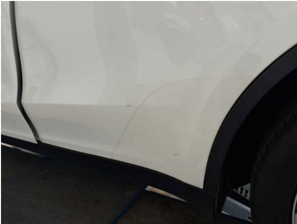
Beschädigung #3: Tür hinten links: Tür - verkratzt / verschürft - instandsetzen und lackieren
