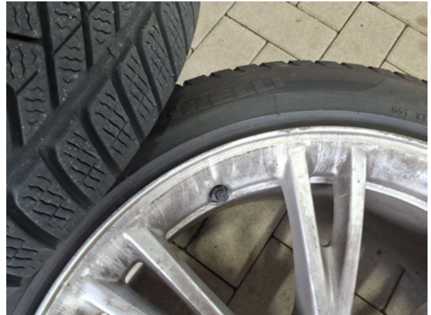
Beschädigung #4: 2.Radsatz: Leichtmetallfelgensatz komplett - verkratzt / verschürft - erneuern
