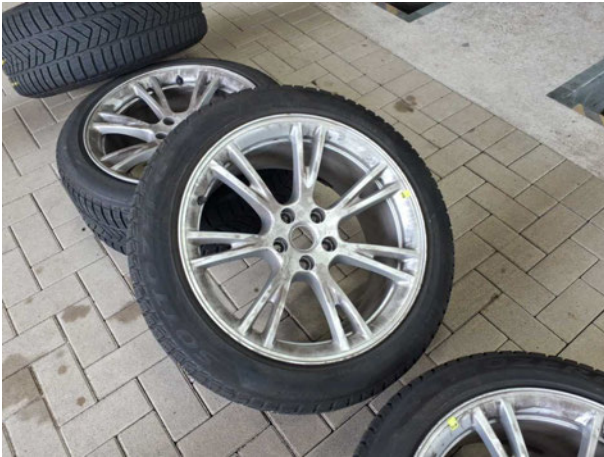
Beschädigung #4: 2.Radsatz: Leichtmetallfelgensatz komplett - verkratzt / verschürft - erneuern
