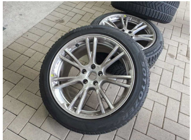
Beschädigung #4: 2.Radsatz: Leichtmetallfelgensatz komplett - verkratzt / verschürft - erneuern
