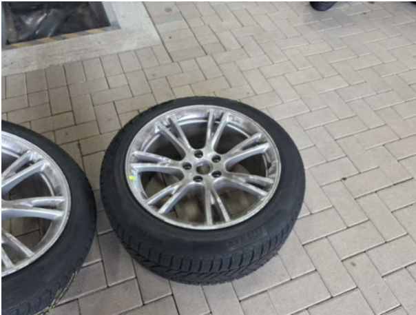
Beschädigung #4: 2.Radsatz: Leichtmetallfelgensatz komplett - verkratzt / verschürft - erneuern
