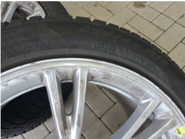
Beschädigung #4: 2.Radsatz: Leichtmetallfelgensatz komplett - verkratzt / verschürft - erneuern
