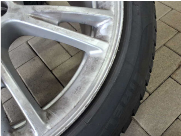
Beschädigung #4: 2.Radsatz: Leichtmetallfelgensatz komplett - verkratzt / verschürft - erneuern
