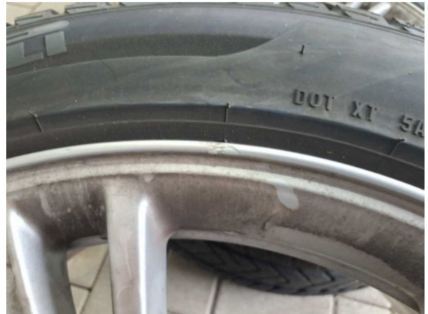
Beschädigung #4: 2.Radsatz: Leichtmetallfelgensatz komplett - verkratzt / verschürft - erneuern
