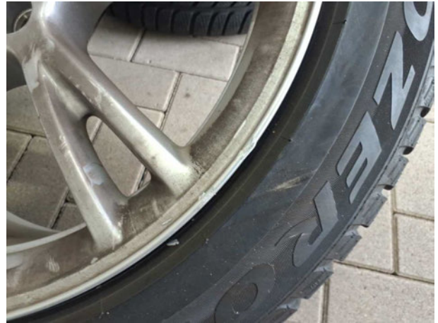
Beschädigung #4: 2.Radsatz: Leichtmetallfelgensatz komplett - verkratzt / verschürft - erneuern
