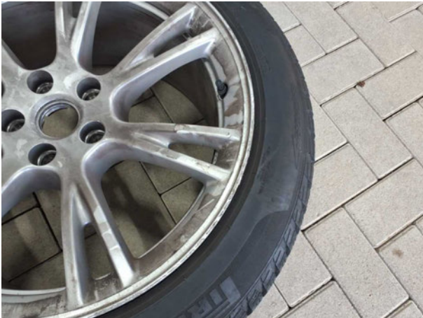
Beschädigung #4: 2.Radsatz: Leichtmetallfelgensatz komplett - verkratzt / verschürft - erneuern
