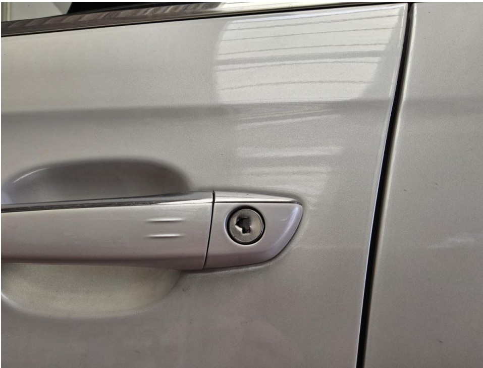
Schließzylinder vorn links beschädigt (REPARIERT)
