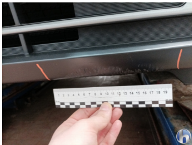
3. Frontspoiler Beschädigt - Erneuern
