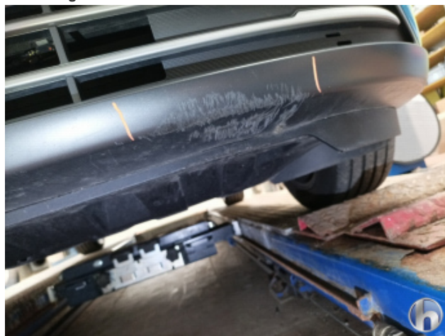
3. Frontspoiler Beschädigt - Erneuern
