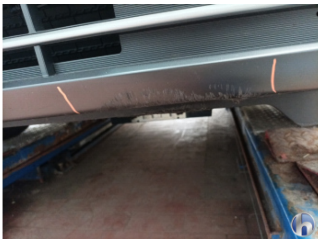
3. Frontspoiler Beschädigt - Erneuern
