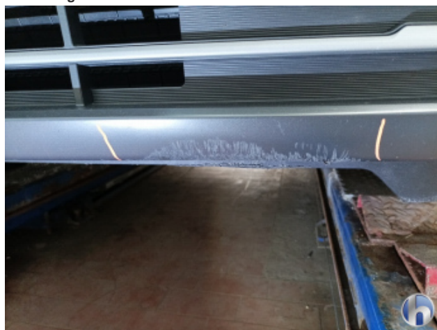
3. Frontspoiler Beschädigt - Erneuern
