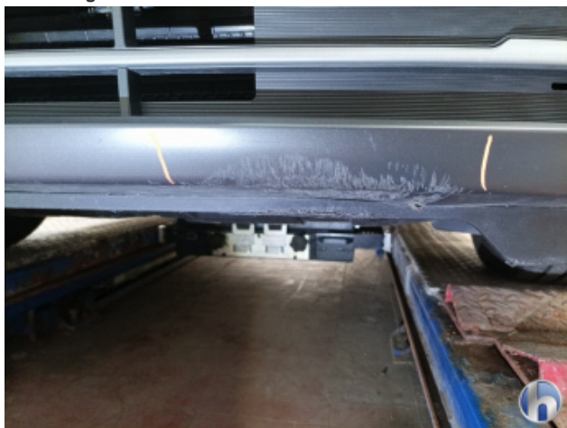
3. Frontspoiler Beschädigt - Erneuern
