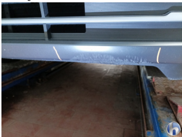
3. Frontspoiler Beschädigt - Erneuern
