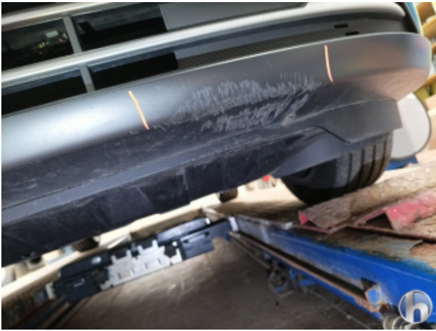
3. Frontspoiler Beschädigt - Erneuern
