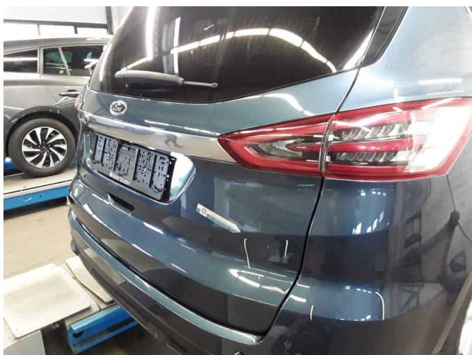
Damage 4: Boot lid / rear door: Boot lid (Klarlack abgeblättert) - Paint defect - Lacquer
