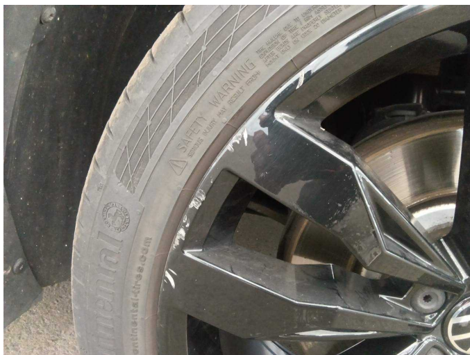
Damage 7: Wheel / tyres: Alloy rim - front right side (+ beide Felgen an der Hinterachse) - Scratch(es) - Replace
