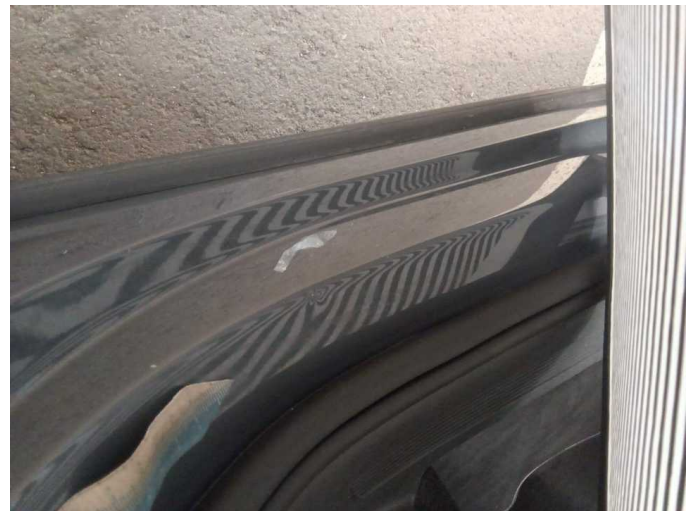
Damage 1: Side panel - rear left side: Sill (Seitenwand Kniestück) - Dent / paintcoat damage - Smart repair
