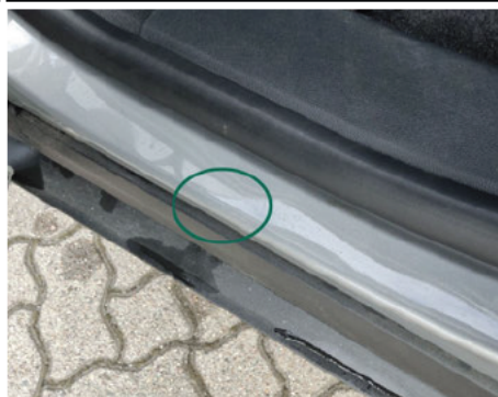
Türeinstieg / Hinten Links / Kratzer
