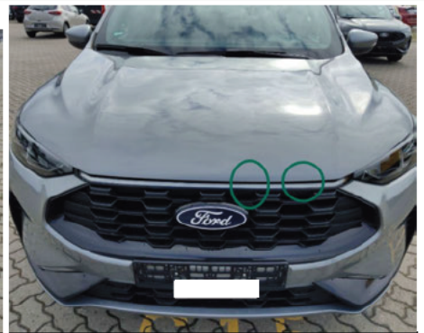
Motorhaube / Vorne / Delle
