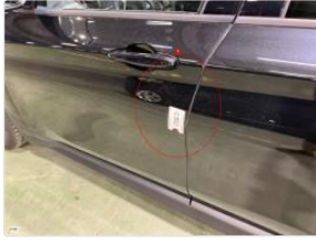
4 - Inner door sill RL - Dent(s)
