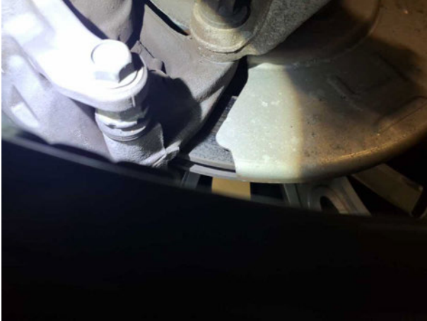
Beschädigung #1: Bremsanlage: Bremsscheiben hinten (frei bremsen... - Korrosion - instandsetzen
