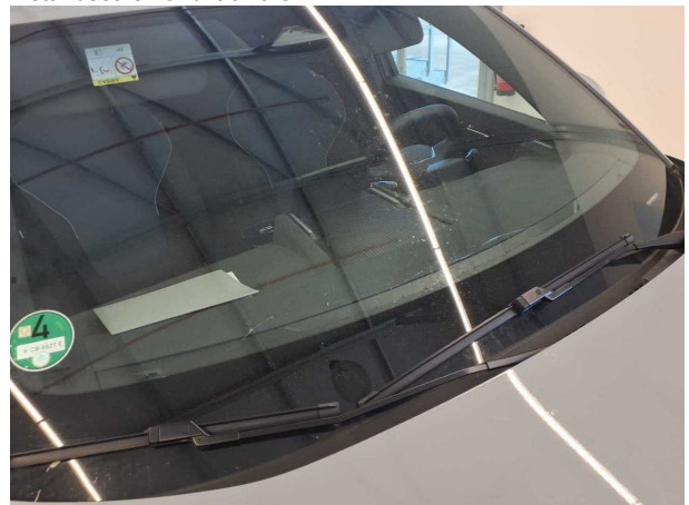
Beschädigung #8: Verglasung: Frontscheibe - gebrochen / gerissen - erneuern
