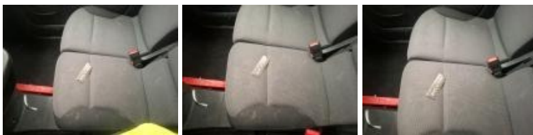
Revêtement assise siège AVG, Tache, Nettoyer
