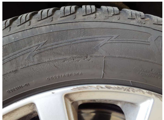
Damage 4: Wheel / tyres: Tyre - front right side (kein Bestandteil der Ausstattung) - Porous / cracked - No deduction
