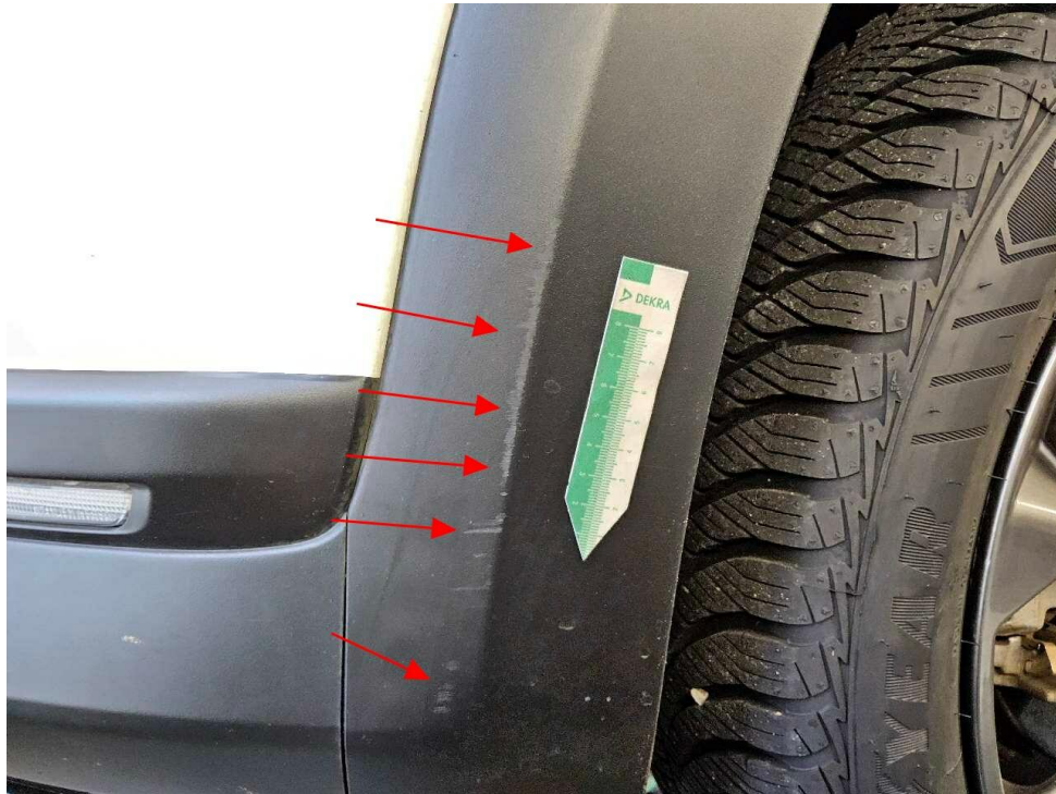
Bild 15 : Radlaufblende vorne links zerkratzt
