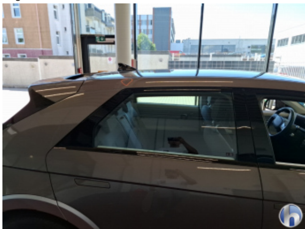
2. Dachrahmen - Rechts 1 Delle - Sanft Instandsetzen
