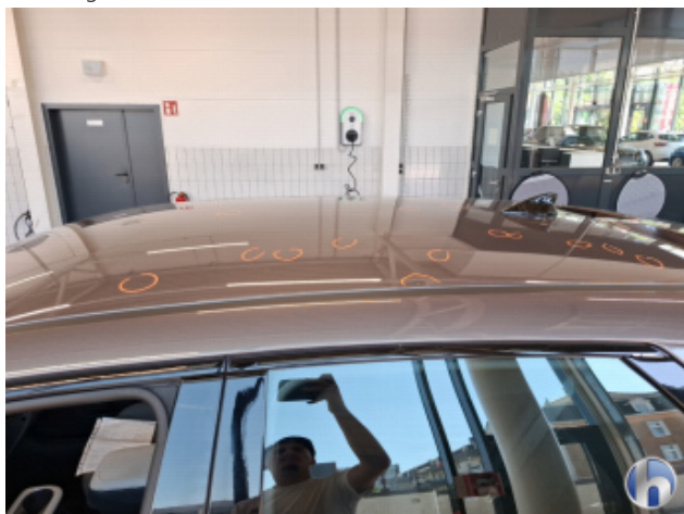
1. Dach Hagelschaden - Sanft Instandsetzen
