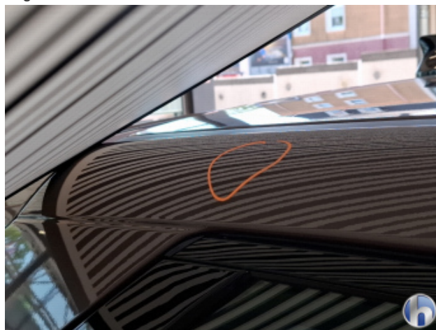
2. Dachrahmen - Rechts 1 Delle - Sanft Instandsetzen
