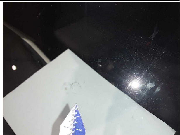
Beschädigung #10: Verglasung: Frontscheibe - Steinschlag - erneuern
