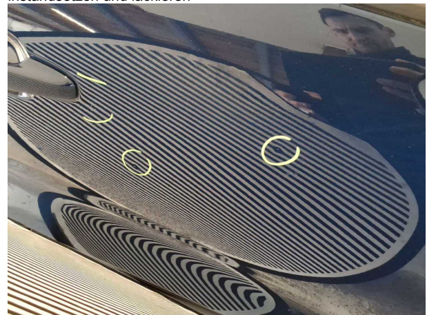
Beschädigung #7: Tür vorn rechts: Tür - Delle / Lackschaden - instandsetzen und lackieren
