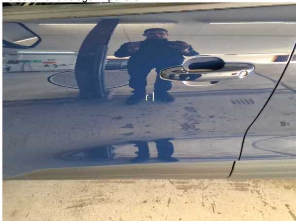
Beschädigung #3: Tür vorn links: Tür - verkratzt / verschürft - auslegen / polieren
