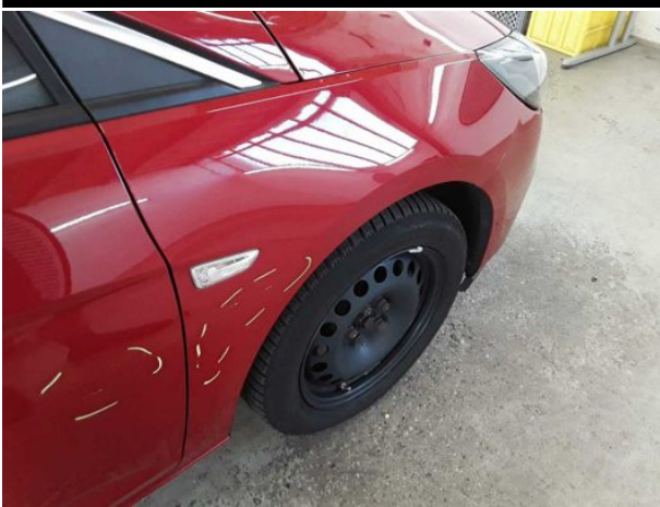
Beschädigung #11: Kotflügel rechts: Kotflügel rechts - verkratzt / verschürft - instandsetzen und lackieren
