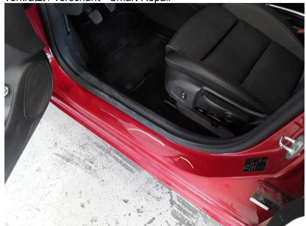
Beschädigung #8: Schweller links: Einstieg - Delle / Lackschaden - Smart Repair
