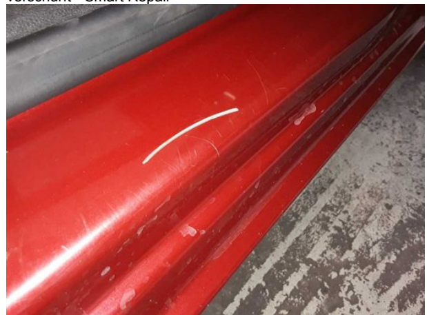
Beschädigung #6: Schweller rechts: Einstieg - verkratzt / verschürft - reinigen
