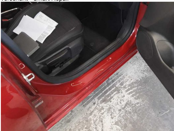
Beschädigung #6: Schweller rechts: Einstieg - verkratzt / verschürft - reinigen
