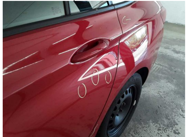
Beschädigung #10: Tür hinten links: Tür - Delle(n) - sanft instandsetzen
