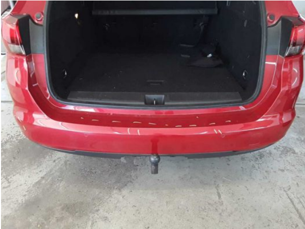
Beschädigung #12: Stossfänger hinten: Stossfänger hinten - verkratzt / verschürft - instandsetzen und lackieren
