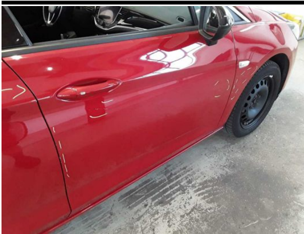
Beschädigung #14: Tür vorn rechts: Tür - verkratzt / verschürft - instandsetzen und lackieren
