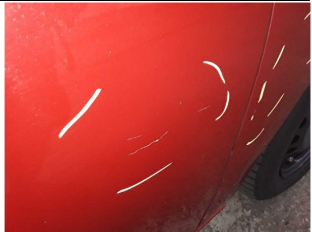
Beschädigung #14: Tür vorn rechts: Tür - verkratzt / verschürft - instandsetzen und lackieren
