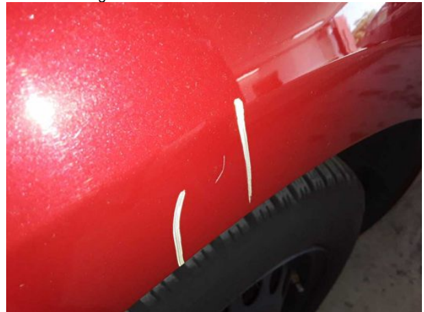
Beschädigung #3: Kotflügel links: Kotflügel links - verkratzt / verschürft - Smart Repair
