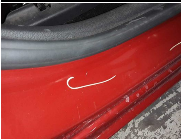
Beschädigung #6: Schweller rechts: Einstieg - verkratzt / verschürft - reinigen
