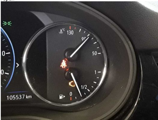
Damage #9: Instrument panel: Indicator light (Motorkontrollleuchte leuchtet) - Specify findings - Perform diagnosis
