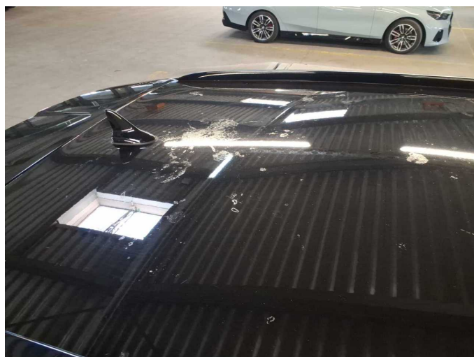
Damage 10: Roof: Roof (Verätzungen) - Paint defect - Paint
