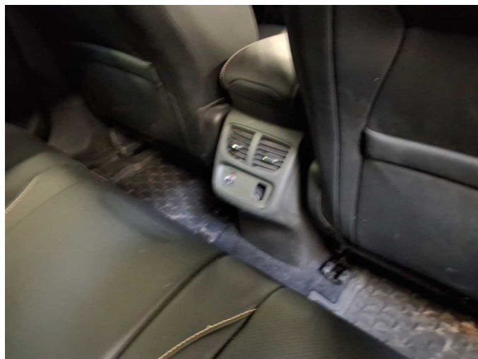
Damage 1: Electrical system: Switch (Sitz Heizung hinten) - Damaged - Replace
