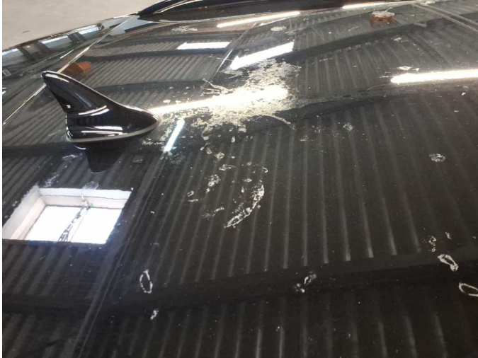
Damage 10: Roof: Roof (Verätzungen) - Paint defect - Paint
