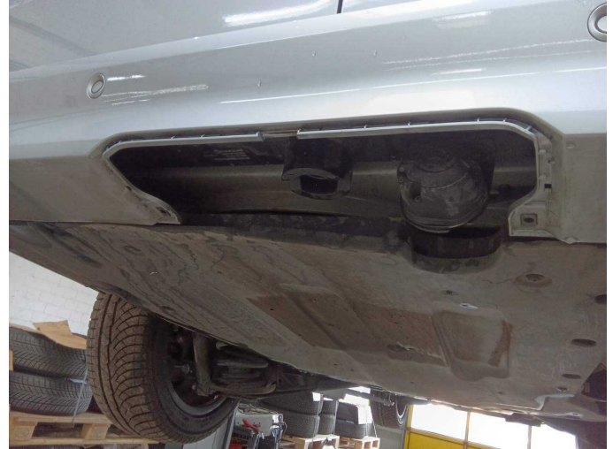
Damage 2: Rear bumper: Cap (Ausschnitt Anhängerkupplung) - Missing - Replace
