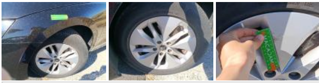
Alloy rim FR, Scratch(es), Repair/replace (lump sum)
