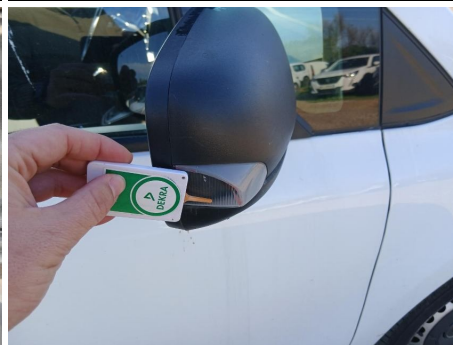
Piloto del intermitente / Derecha / Roto
