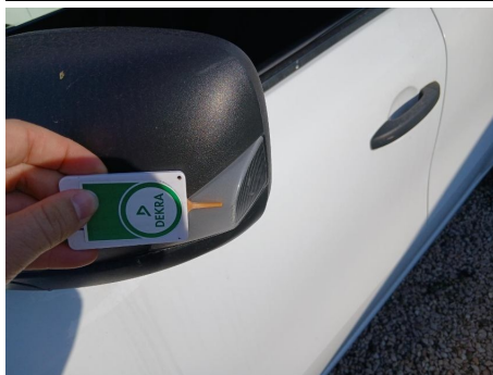
Piloto del intermitente / Izquierda / Roto
