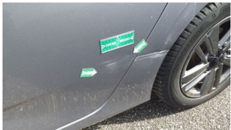
Porte / Arrière Gauche / Enfoncement
