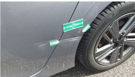
Aile / Arrière Gauche / Enfoncement
