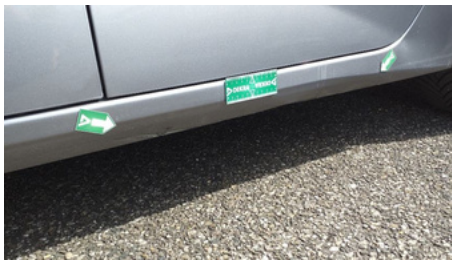
Bas de caisse / Gauche / Enfoncement
