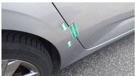
Aile / Arrière Droit / Enfoncement
