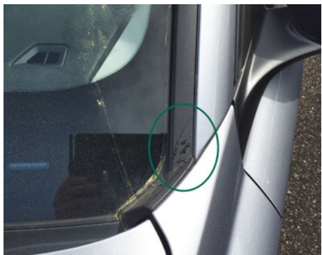
Joint de pare-brise / Gauche / Usé
