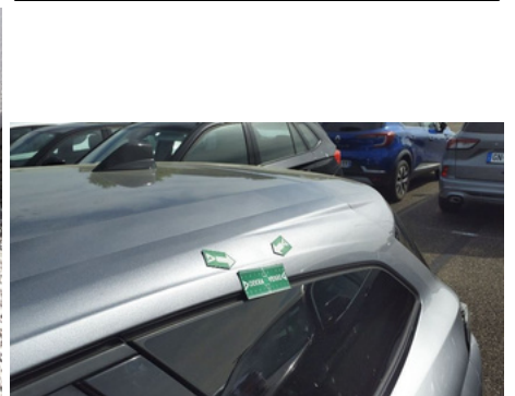
Montant de pavillon / Gauche / Enfoncement
