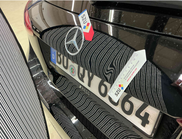
Heckklappe Verformung Reparatur €
