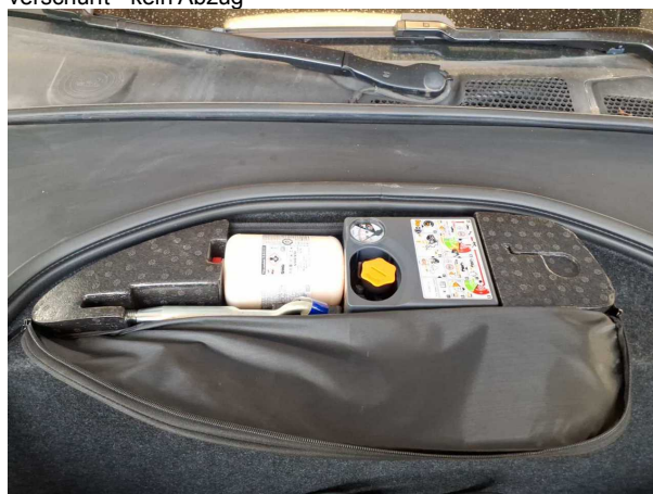
Beschädigung #3: Ausrüstung: Tirefit Füllmittel - abgelaufen - erneuern
