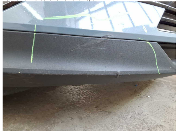
Beschädigung #6: Stossfänger vorn: Spoiler - verkratzt / verschürft - erneuern
