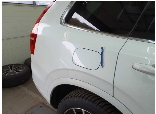
Beschädigung #4: Seitenwand rechts: Seitenwand - nicht fachgerecht instandgesetzt - instandsetzen und lackieren
