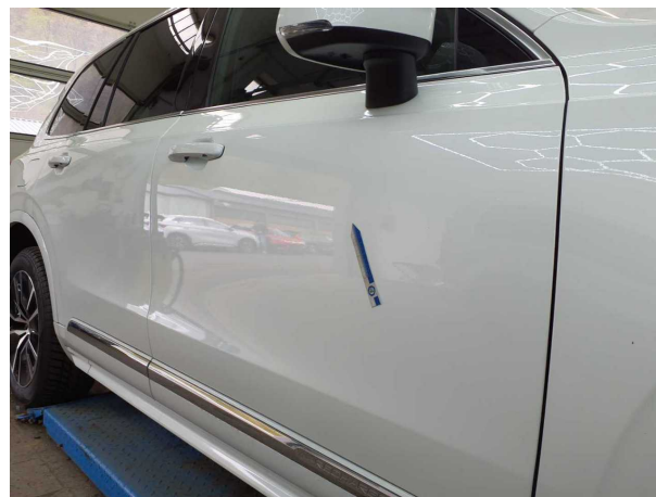
Beschädigung #5: Tür vorn rechts: Tür - nicht fachgerecht instandgesetzt - instandsetzen und lackieren
