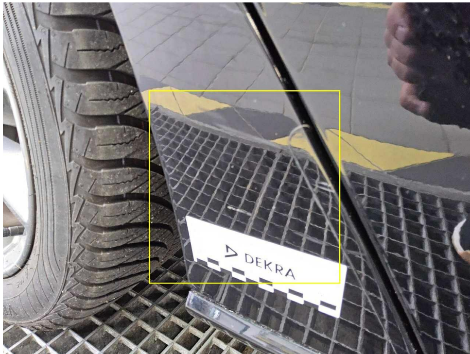
Bild 20 : Seitenteil hinten rechts, eingedellt, instandsetzen und lackieren mit Lackaufbau
