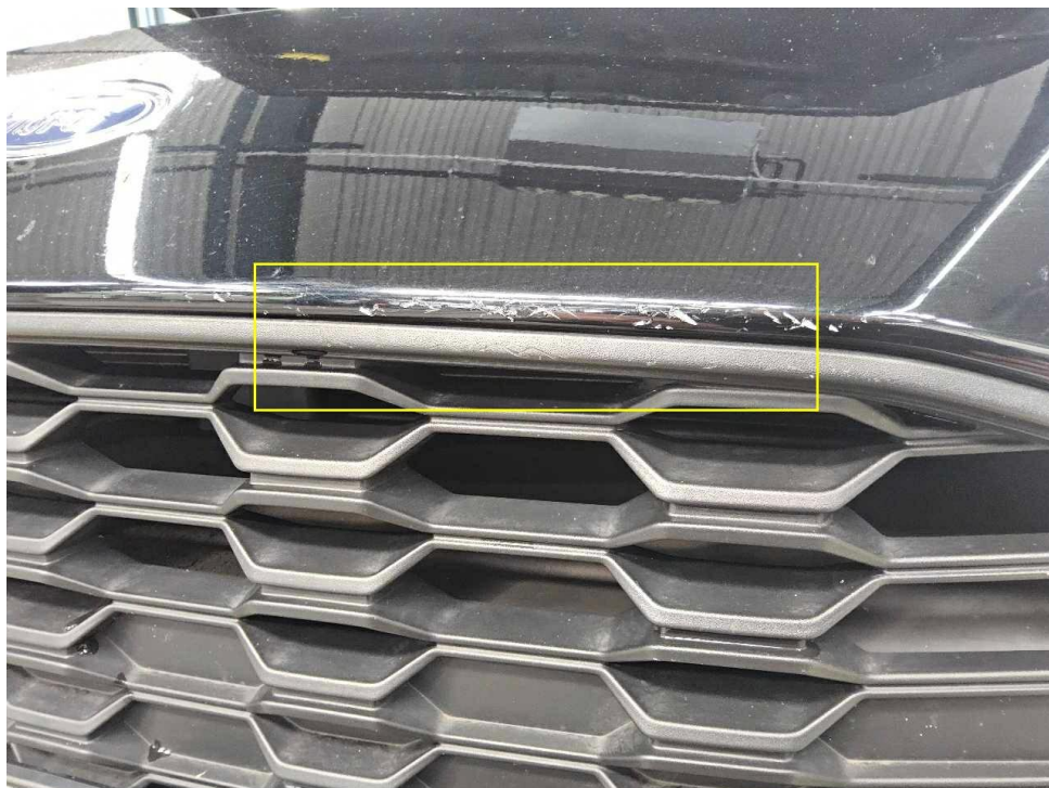
Bild 13 : Kühlergrill, verschrammt und eingekerbt
