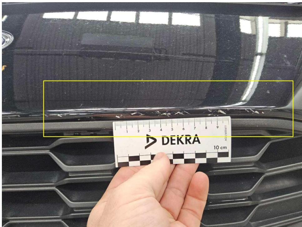
Bild 25 : Stoßfänger vorne Lackierung, verschrämmt, lackieren mit Lackaufbau
