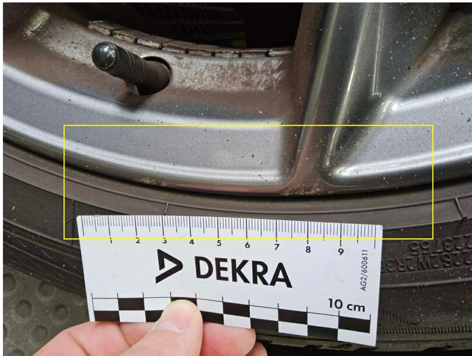
Bild 22 : Felge vorne rechts Lackierung, zerkratzt, Gebrauchsspur
