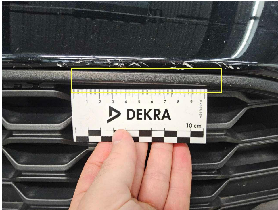
Bild 12 : Kühlergrill, verschrammt und eingekerbt
