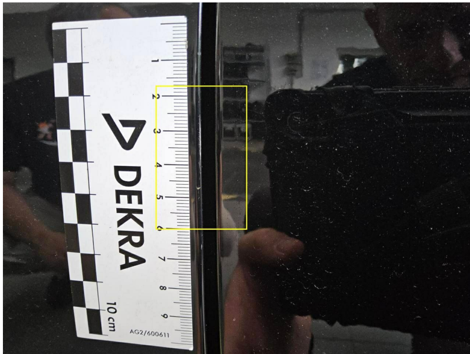
Bild 24 : Tür vorne links Türkante, Lackabplatzer, Gebrauchsspur
