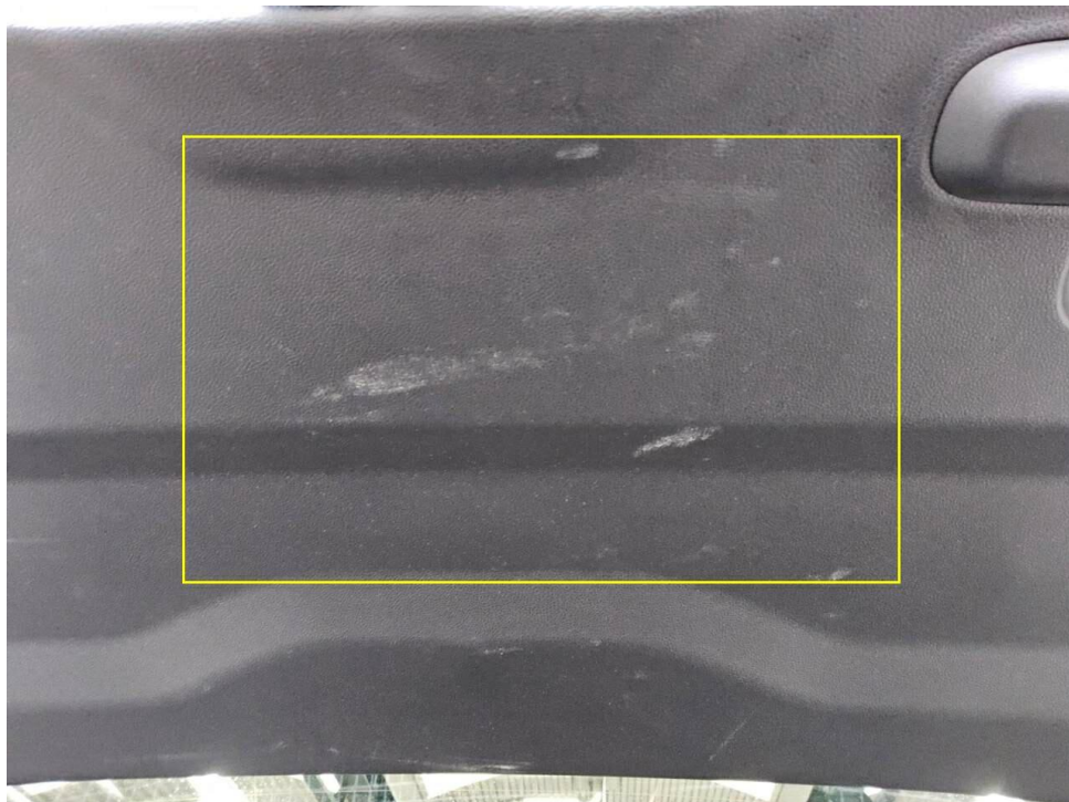
Bild 23 : Verkleidung Heckklappe, zerkratzt, Gebrauchsspur
