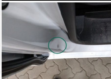
Säule / Vorne Rechts / Delle
