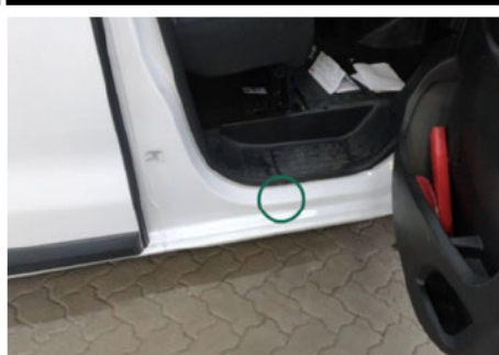
Säule / Vorne Rechts / Delle
