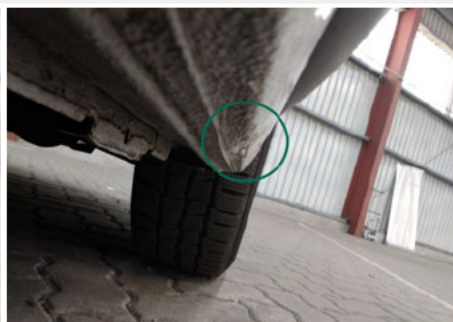
Schweller / Vorne Rechts / Delle
