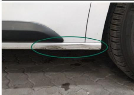
Schweller / Vorne Rechts / Delle
