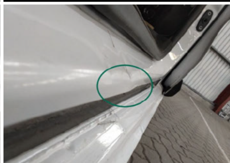
Türeinstieg / Rechts / Delle
