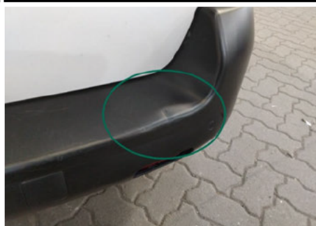
Stoßfänger / Hinten / Delle
