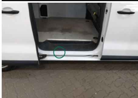
Türeinstieg / Rechts / Delle
