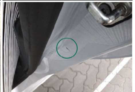
Säule / Vorne Links / Delle
