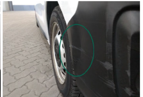
Stoßfänger unterhalb / - / Delle
