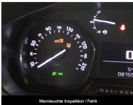
Warnleuchte Inspektion / Fehlt
