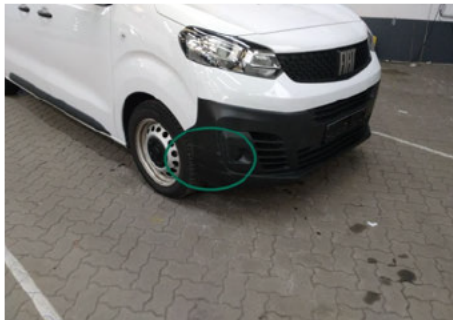
Stoßfänger unterhalb / - / Delle
