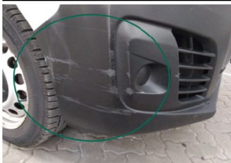
Stoßfänger unterhalb / - / Delle
