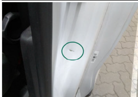
Säule / Vorne Links / Delle
