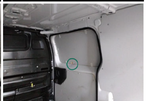
Innenverkleidung Laderaum / Oben Vorne Rechts / Gebrochen
