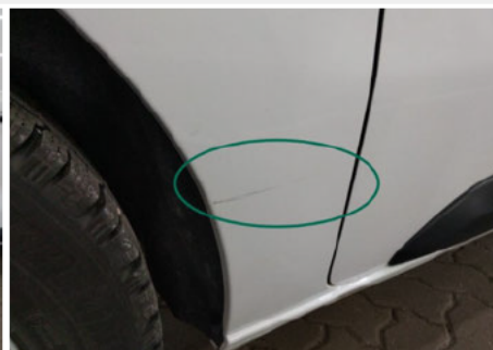
Seitenwand / Unten Rechts / Kratzer
