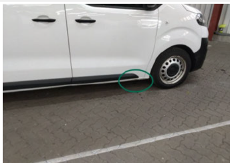
Schweller / Vorne Rechts / Delle
