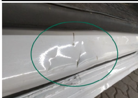
Türeinstieg / Rechts / Delle
