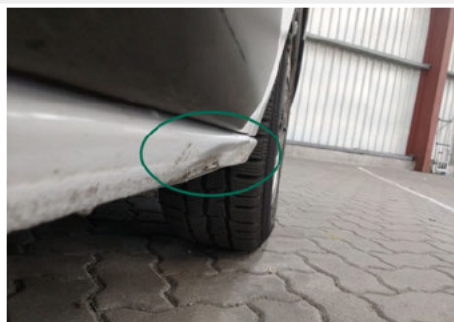
Schweller / Vorne Rechts / Delle
