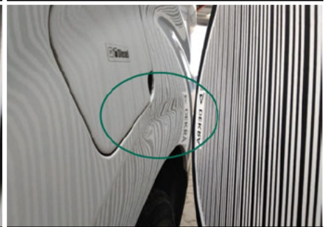
Seitenwand / Unten Links / Delle
