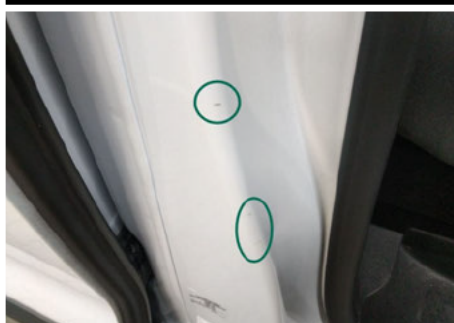
Säule / Vorne Rechts / Delle
