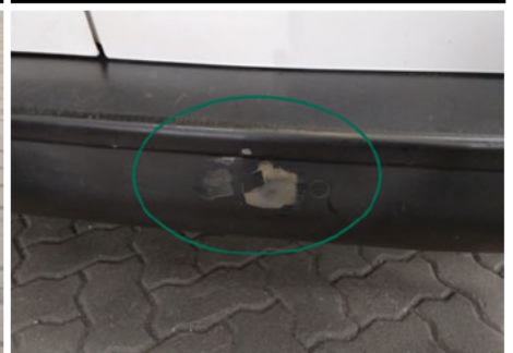
Stoßfänger / Hinten / Delle
