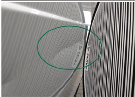
Seitenwand / Unten Links / Delle
