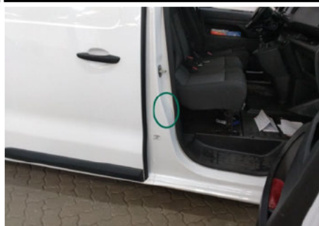
Säule / Vorne Rechts / Delle
