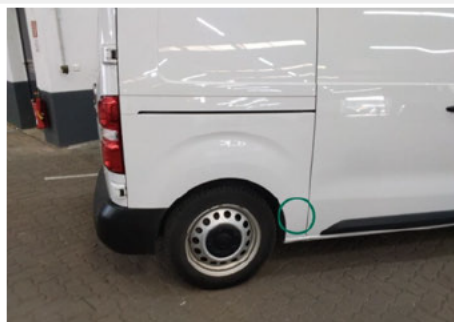
Seitenwand / Unten Rechts / Kratzer
