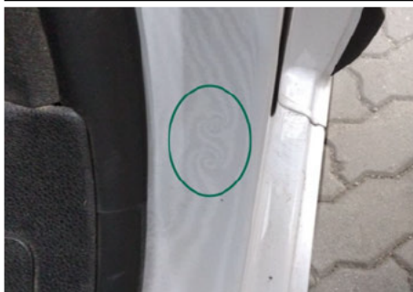
Säule / Vorne Links / Delle
