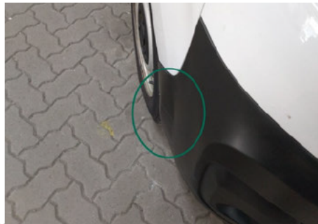
Stoßfänger unterhalb / - / Delle
