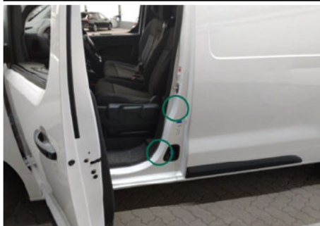
Säule / Vorne Links / Delle
