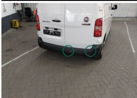
Stoßfänger / Hinten / Delle
