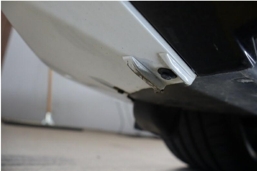
Bild 18 : Stoßfängerverkleidung vorn verkratzt unterhalb und diverse Steinschläge
