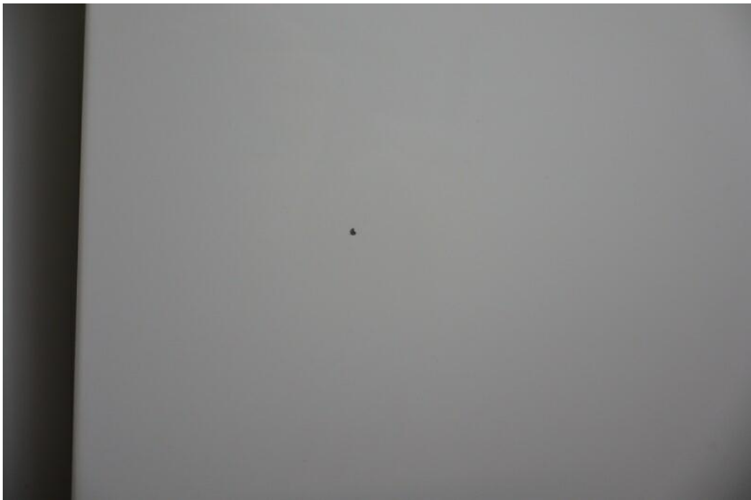
Bild 25 : Tür vorn rechts Steinschläge
