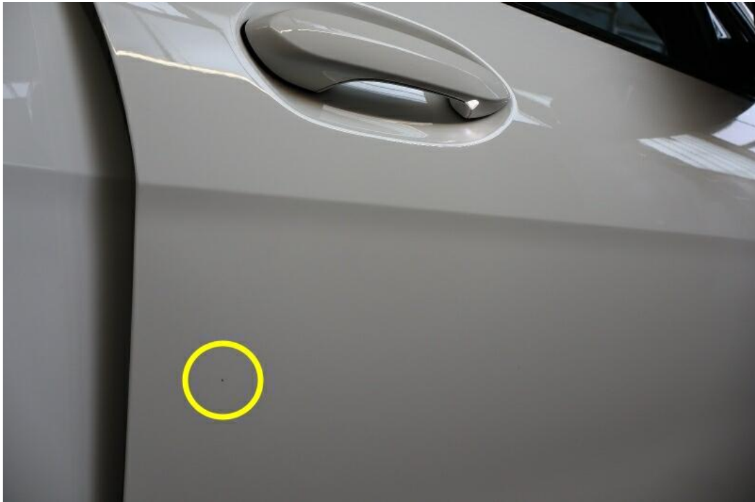
Bild 24 : Tür vorn rechts Steinschläge
