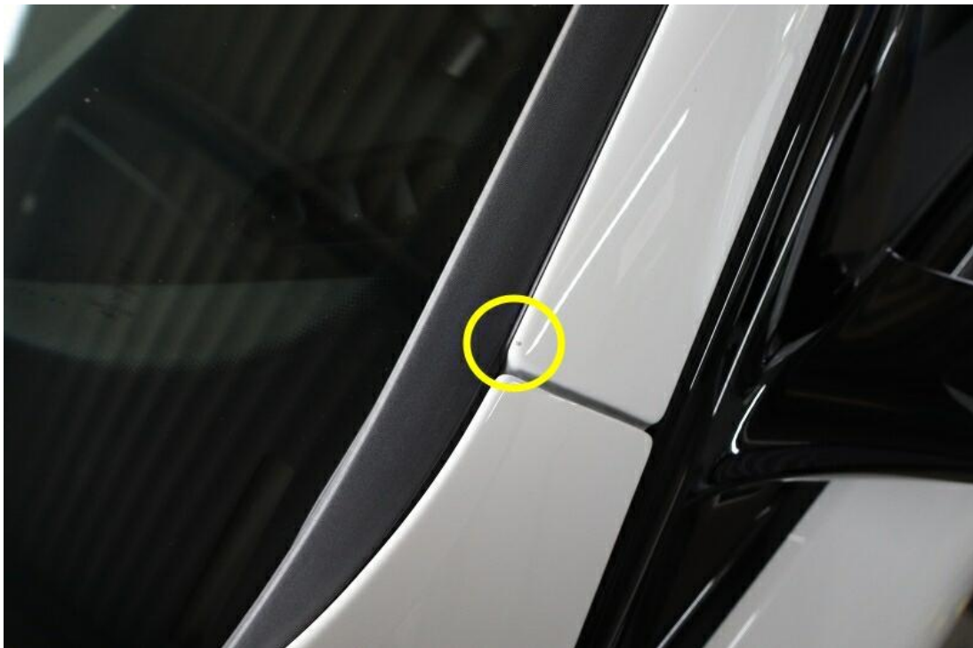
Bild 29 : A-Säule links Steinschlag
