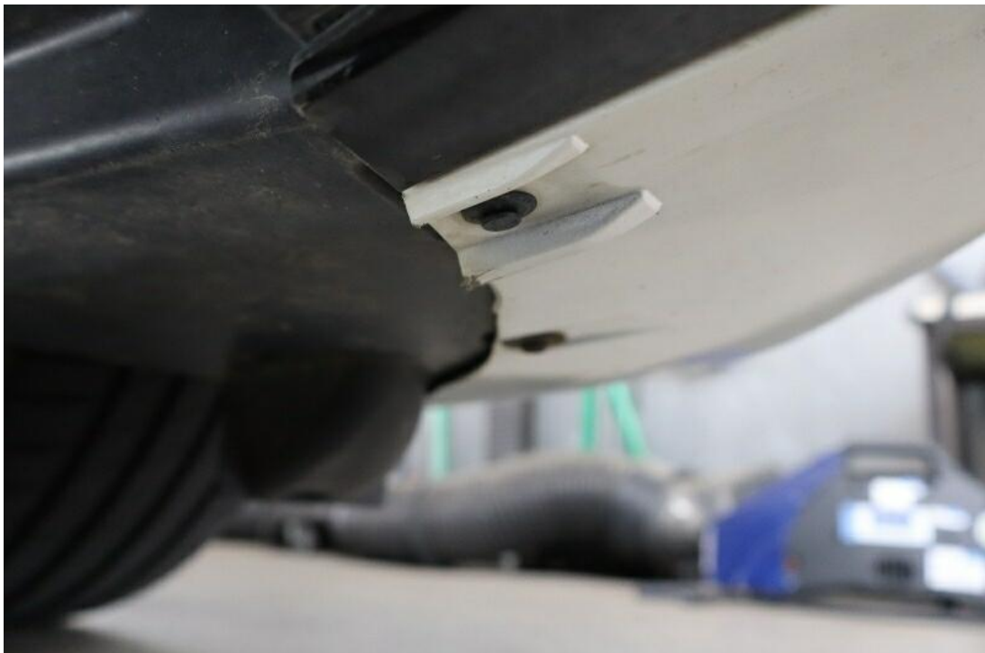
Bild 19 : Stoßfängerverkleidung vorn verkratzt unterhalb und diverse Steinschläge
