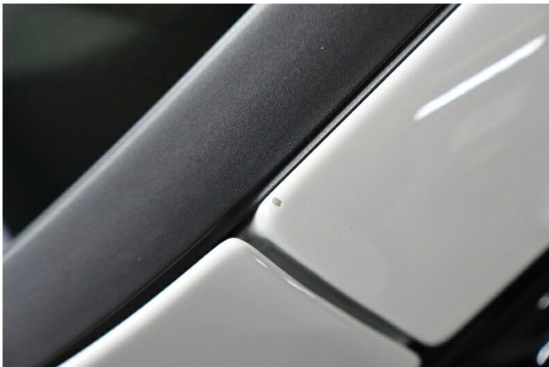
Bild 30 : A-Säule links Steinschlag
