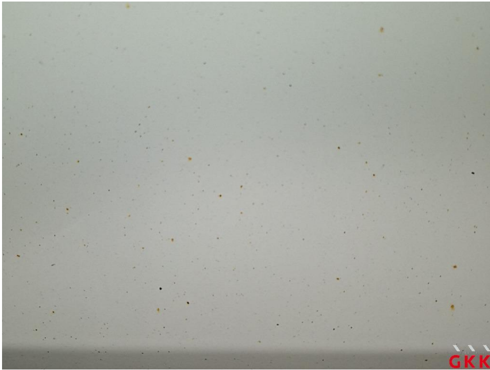
Bild 19 Fahrzeug, außen, Lackierung verwittert / matt, aufbereiten
