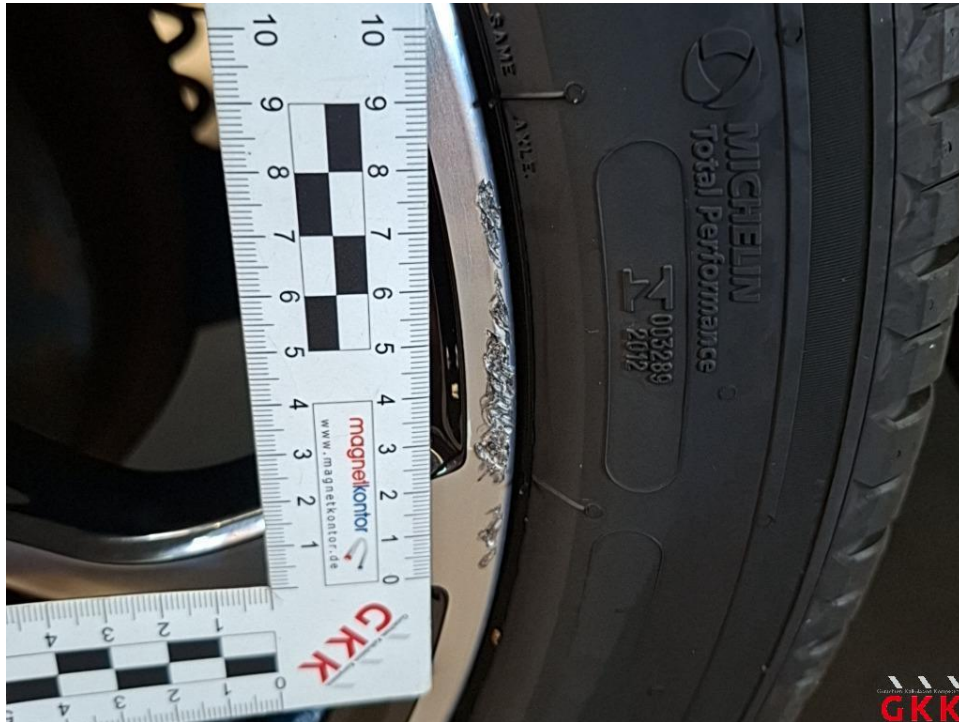
Bild 23 LM-Rad, hinten rechts, verkratzt, ersetzen
