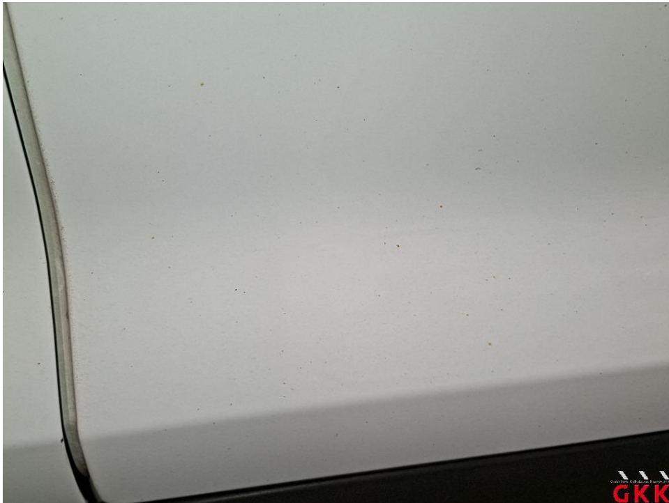
Bild 21 Fahrzeug, außen, Lackierung verwittert / matt, aufbereiten
