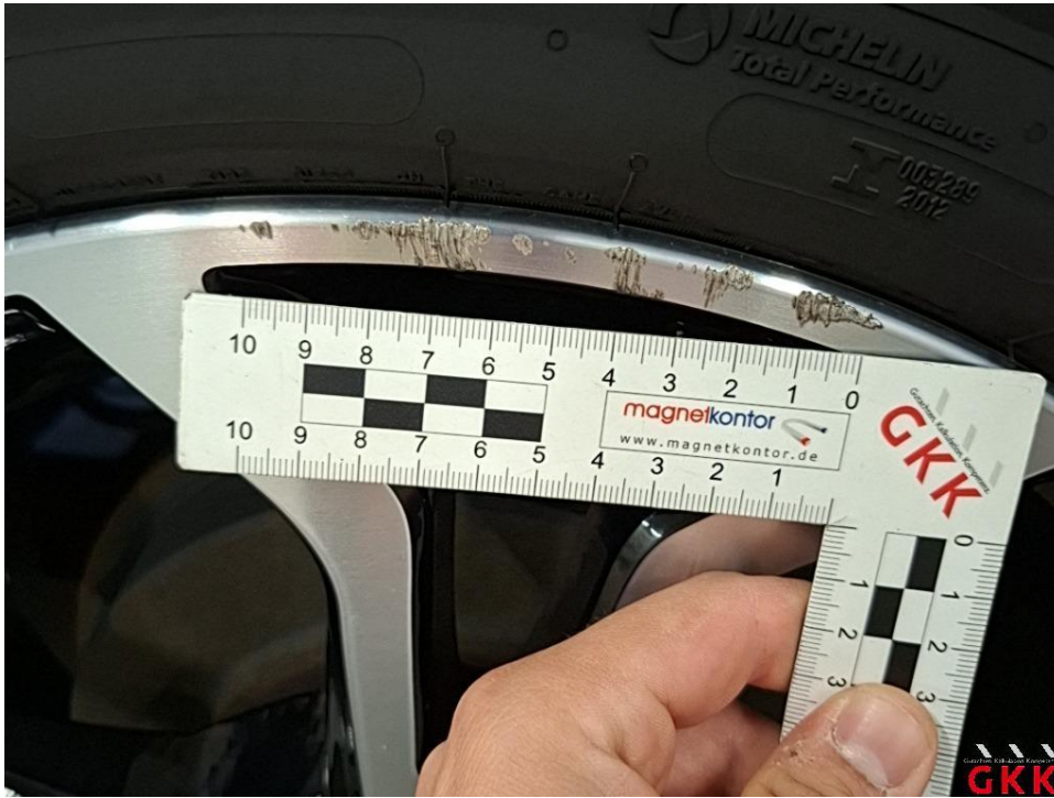
Bild 25 LM-Rad, hinten links, verkratzt, ersetzen
