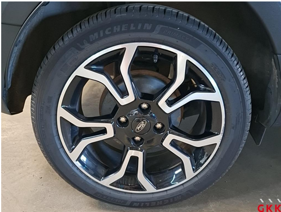
Bild 22 LM-Rad, hinten rechts, verkratzt, ersetzen
