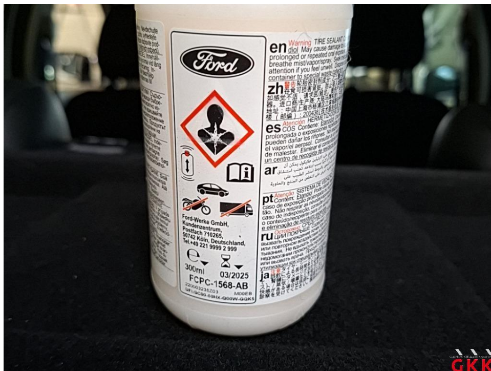
Bild 16 Reifenreparaturset, Füllflasche, MHD überschritten, ersetzen
