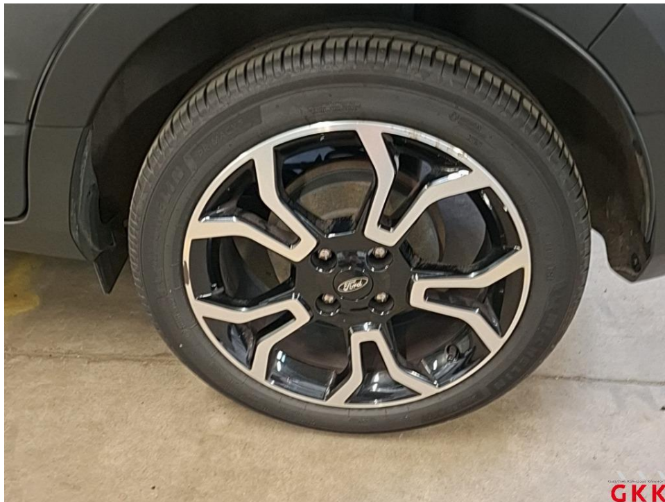
Bild 24 LM-Rad, hinten links, verkratzt, ersetzen
