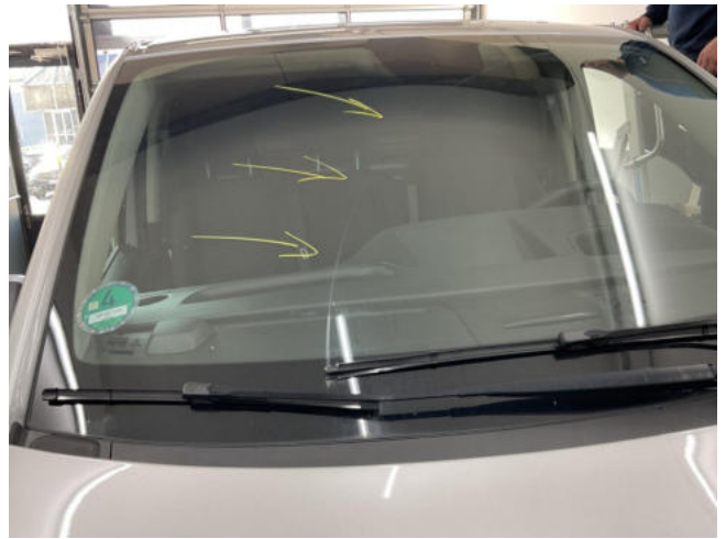
Frontscheibe verkratzt - erneuern
