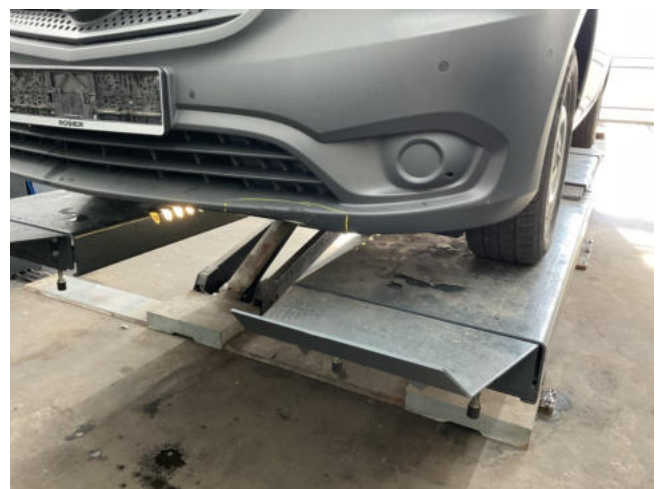
Stossfänger vo deformiert - ersetzen
