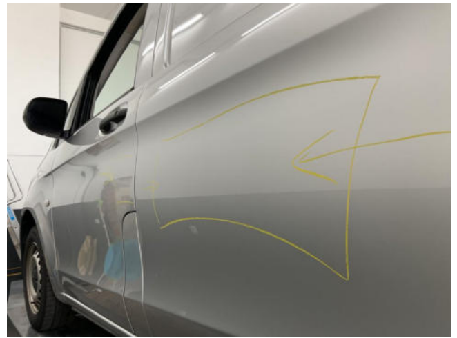
Seitenwand links verdellt - Smart repair
