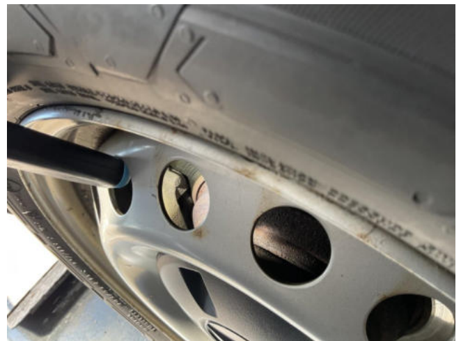
Bremse HA verschlissen - erneuern
