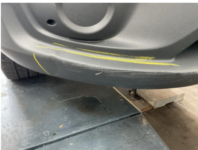
Stossfänger vo deformiert - ersetzen
