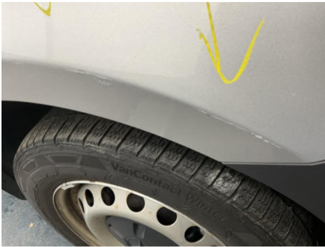
Kotflügel vorne rechts - zerkratzt - Lackieren
