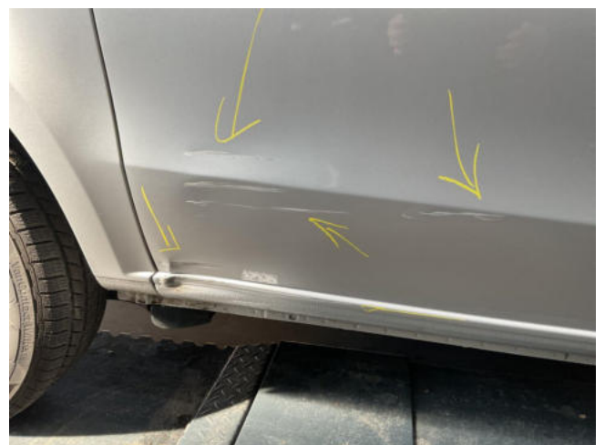
Schiebetür deformiert - erneuern
