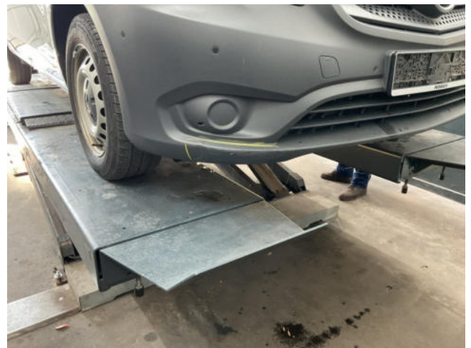
Stossfänger vo deformiert - ersetzen
