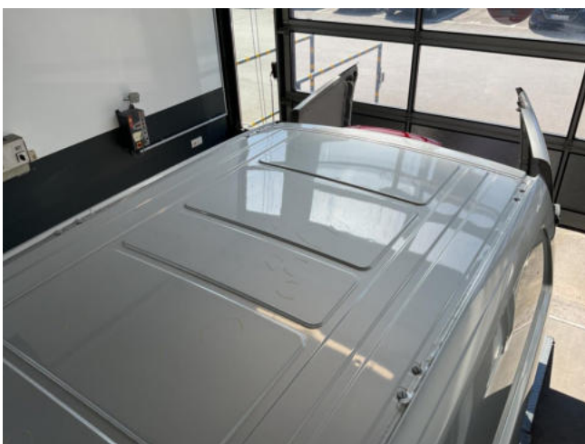
Dach Hagelschaden - Smart repair
