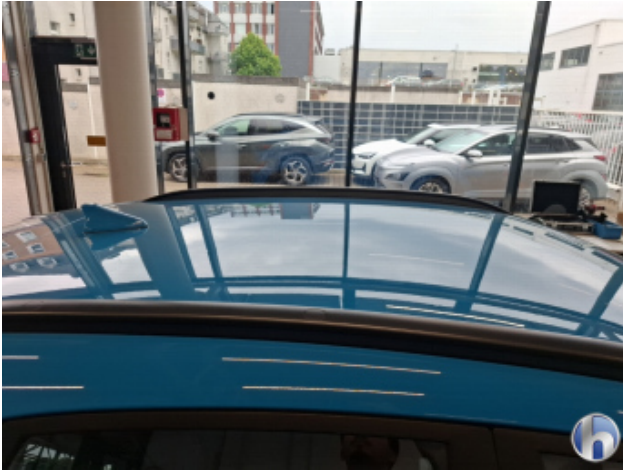
1. Dach 2 Dellen - Sanft Instandsetzen
