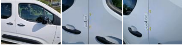
Sliding door R, Scratch(es), Paint
