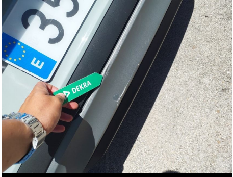
Moldura de paragolpes / Trasero / Abolladura
