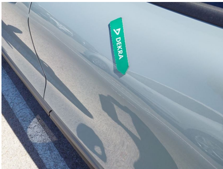
Puerta / Trasero Izquierdo / Abolladura
