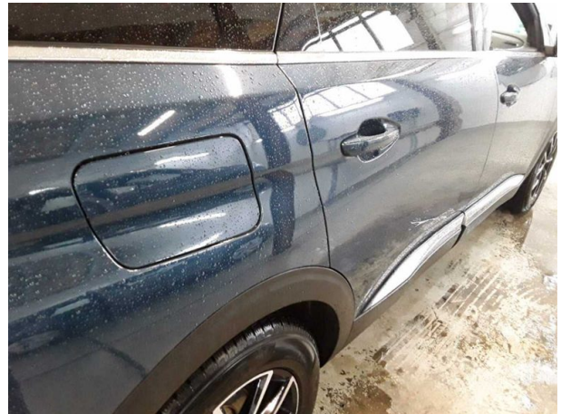
Beschädigung #8: Seitenwand rechts: Seitenwand - verkratzt / verschürft - instandsetzen und lackieren
