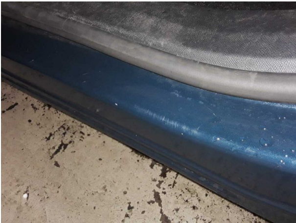
Beschädigung #7: Seitenwand links: Einstieg - verkratzt / verschürft - instandsetzen und lackieren
