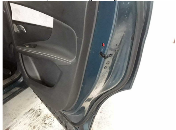
Beschädigung #6: Tür hinten rechts: Tür - Delle(n) - sanft instandsetzen
