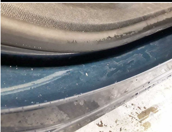
Beschädigung #3: Seitenwand rechts: Einstieg - verkratzt / verschürft - Smart Repair
