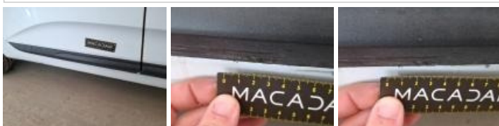
Moulure porte ARD, Déformé / Forcé, E - Remplacer
