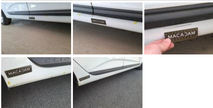
Moulure porte ARD, Déformé / Forcé, E - Remplacer
