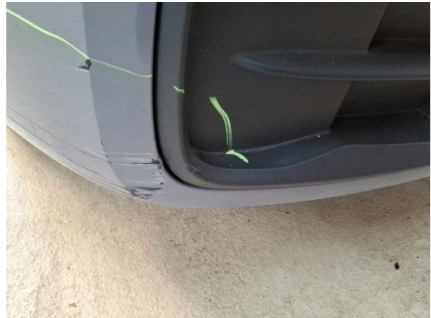
Beschädigung #7: Stossfänger vorn: Lufteinlassgitter - verkratzt / verschürft - erneuern
