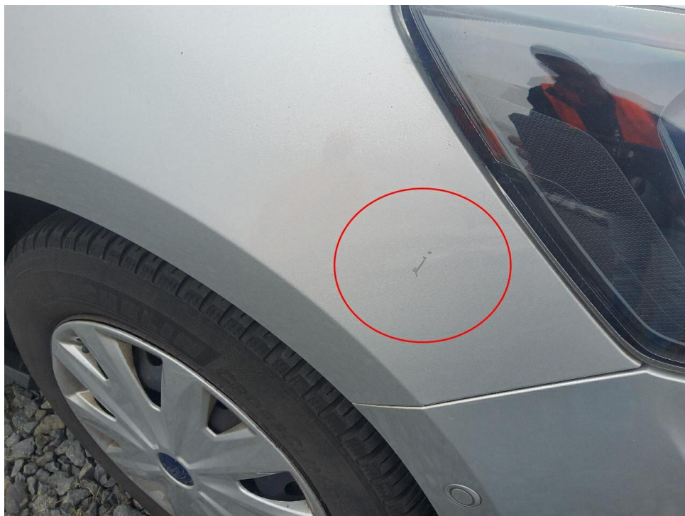
Bild 14 : Kotflügel rechts Kratzer
