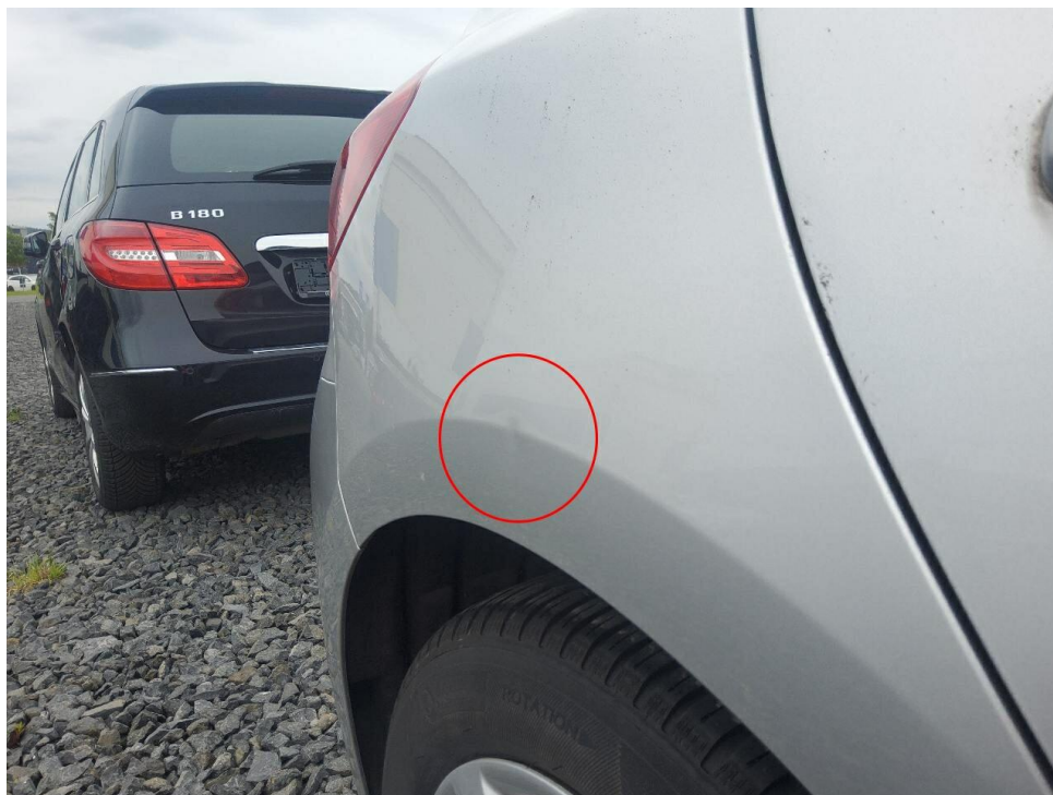
Bild 15 : Seitenwand rechts Delle
