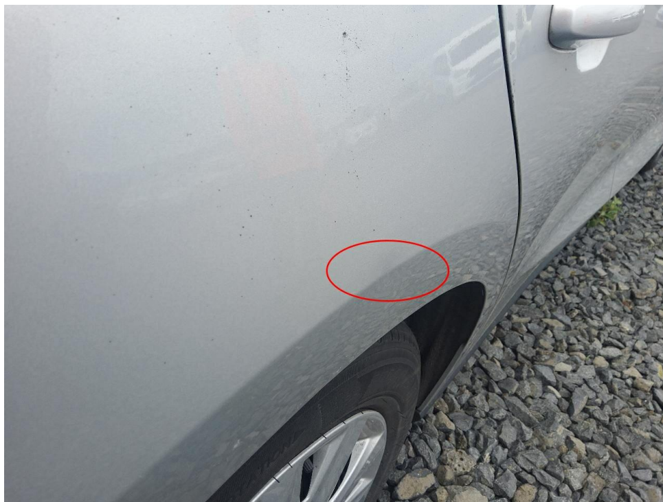
Bild 16 : Seitenwand rechts Delle
