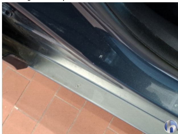
4. Türeinstieg Vorne - Rechts Beschädigt - Smart Repair
