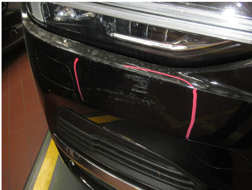
Bild 7 : Stoßfängerverkleidung vorne verschrammt, verformt
