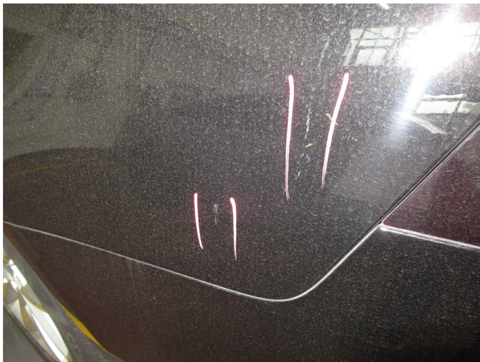
Bild 12 : Seitenwand links zerkratzt
