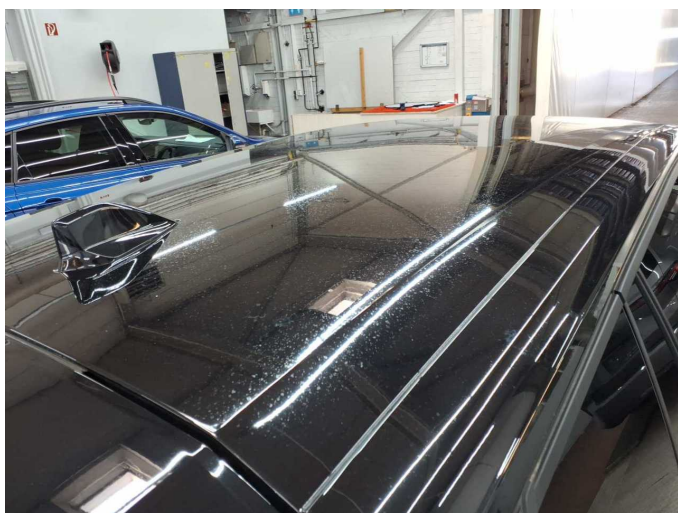
Damage 4: Roof: Roof (Anhaftung Harz-Mehrkosten möglich) - Paint defect - Conditioning
