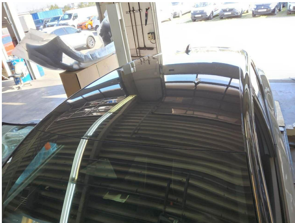
Bild 12 : Dach, eingedellt, drücken
